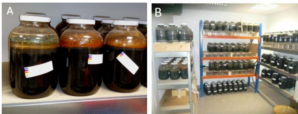
Figure 3-1 : Photographie des sédiments en condition saturée, mise en pot en verre de 4 litres (A) et du lieu de stockage (B).
