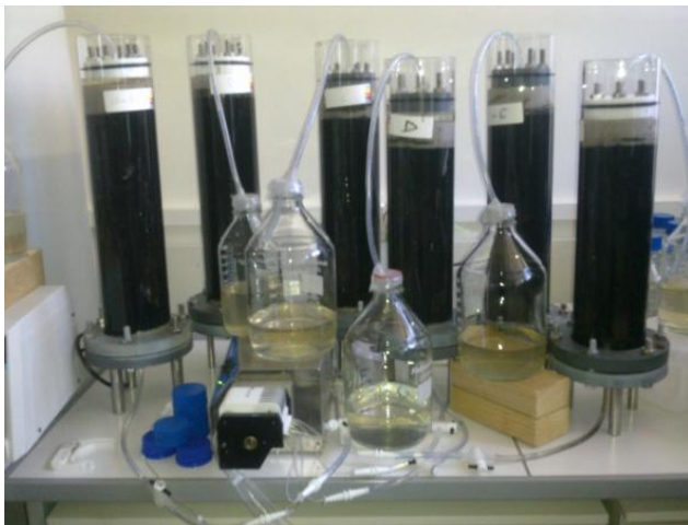
Figure 6-6 : Essais de percolation réalisée dans le laboratoire ARDEVIE.
