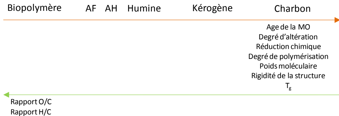
Figure 1-5 : Schéma illustrant l'évolution des caractéristiques de la MO au cours de son altération d'après Hammes et al. (2007).
