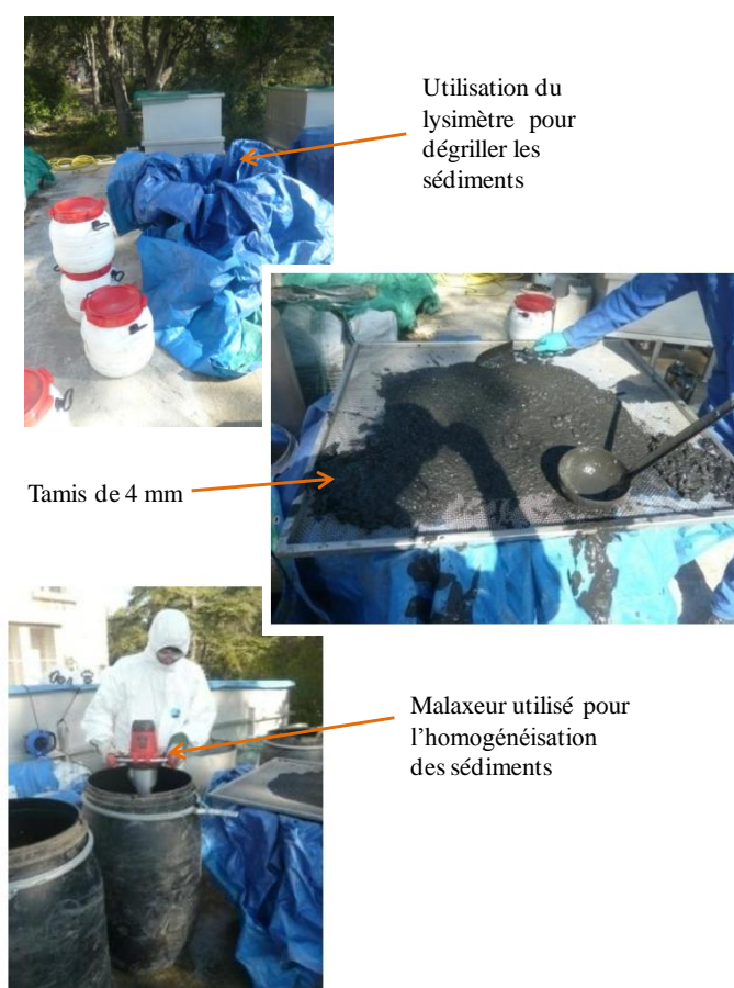
Figure 2-2 : Tamisage et homogénéisation des sédiments
