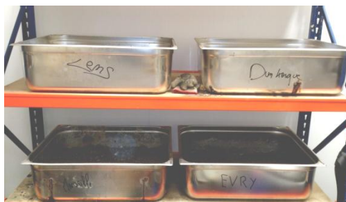
Figure 3-3 : Photographie du dispositif expérimental de vieillissement mis en place pour les sédiments soumis au régime hydrique entre 40 et 60% de la CR.
