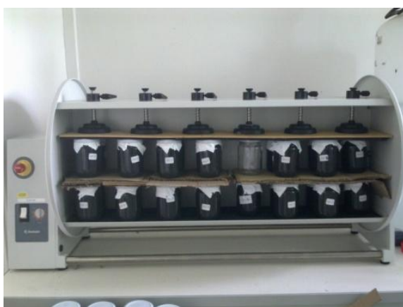
Figure 5-7 : Agitateur rotatif utilisé dans les essais d'accumulation des contaminants sur les membranes LDPE.
