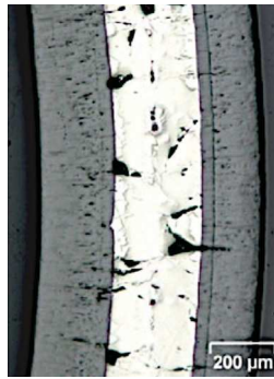
Figure 47 - Métallographie d'une couche d'oxyde formée sous air à 1 100 °C pour un tronçon de gaine de Zy4 [91].
