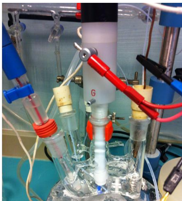
Figure 193. Montage de mesure en électrochimie à base d'électrode modifiée.
