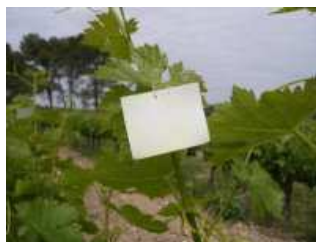
Figure 1.10: Collecteur plastique disposé dans la vigne en vue d'évaluer la qualité de la pulvérisation (source IFV, Sébastien Codis)
