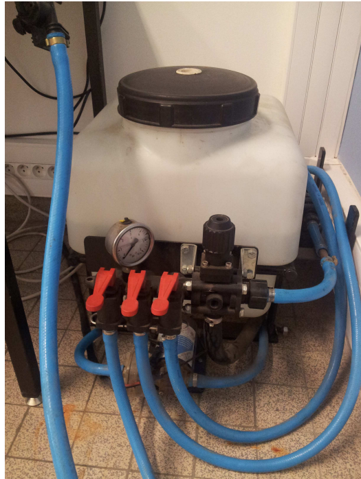
Figure 3.14: Pulvérisateur industriel « Brard et Sarran »
