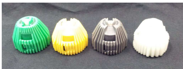
Figure 3.15: Buses « Nozal » de type AFX (de gauche à droite : modèles n°015, 02, 06, 08)
