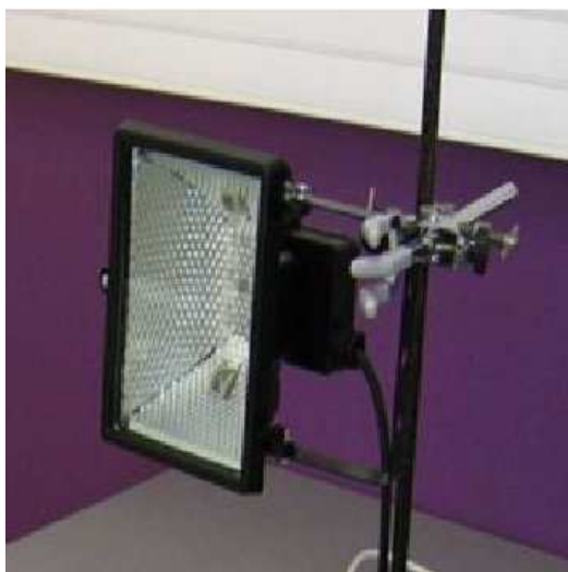
Figure 3.7: Projecteur halogène d'une puissance de 500 W
