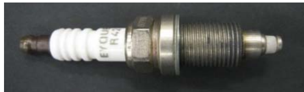
Figure II-9 : Bougie à décharge surfacique avec céramique interélectrode de 3mm.
