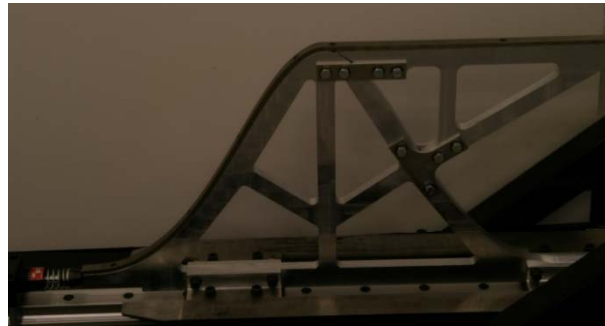
Figure II-6 : Came au profil de compression simple (superposé à un profil de compression détente).
