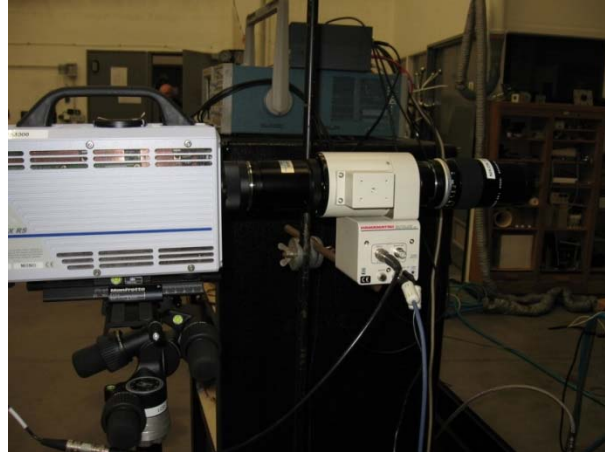
Figure II-21 : Caméra rapide RS3000 équipée de l'intensificateur Hamamatsu.
