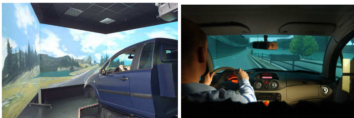
FIG. 6.12 – Simulateur de conduite permettant à un essai humain de piloter le modèle SimulinkCar
