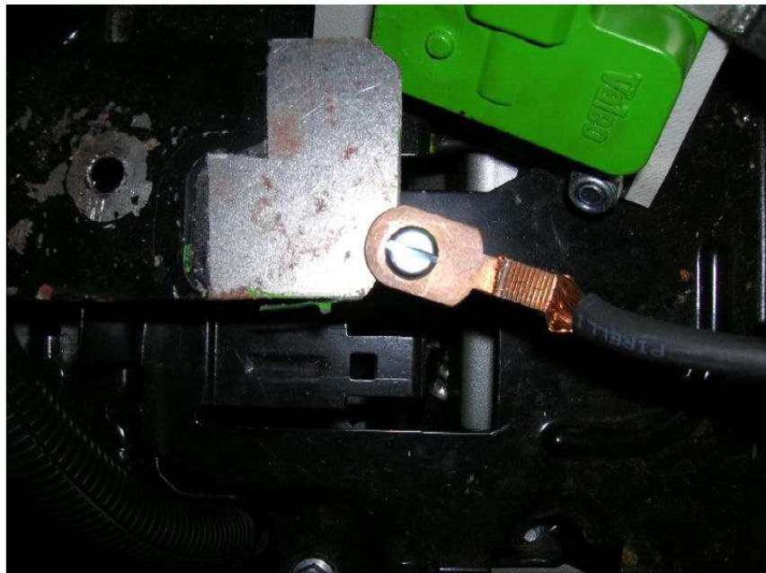
Figure C.8 : Connexion moteur Short BSM
