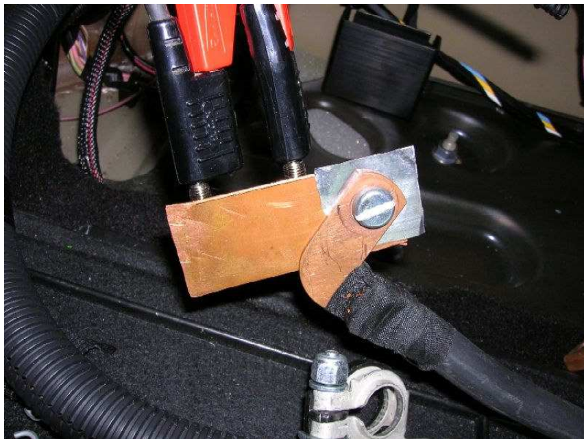
Figure C.4 : Détail connexion Alternateur
