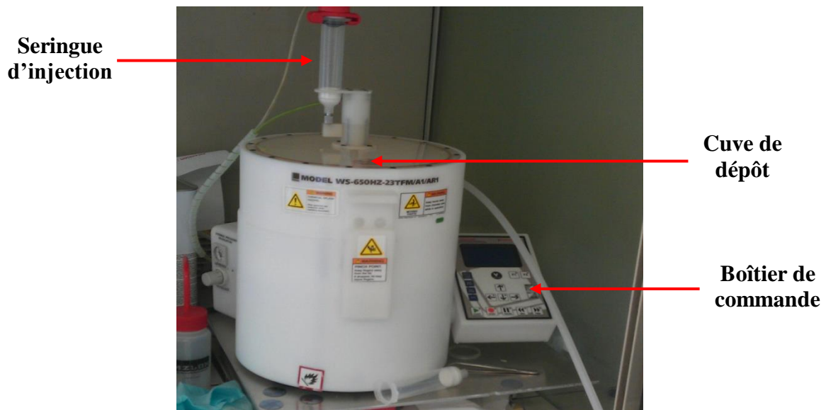
Figure II-22 : Spin-coater utilisé au CIMAP, modèle WS-650HZ-23TFM/A1/AR1 de la marque Laurell®.
