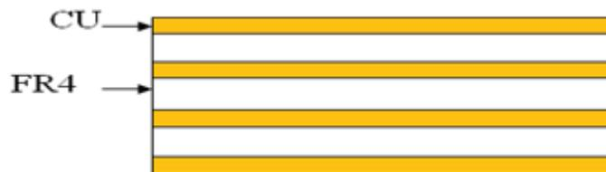
Figure IV. 3: les couches du PCB
