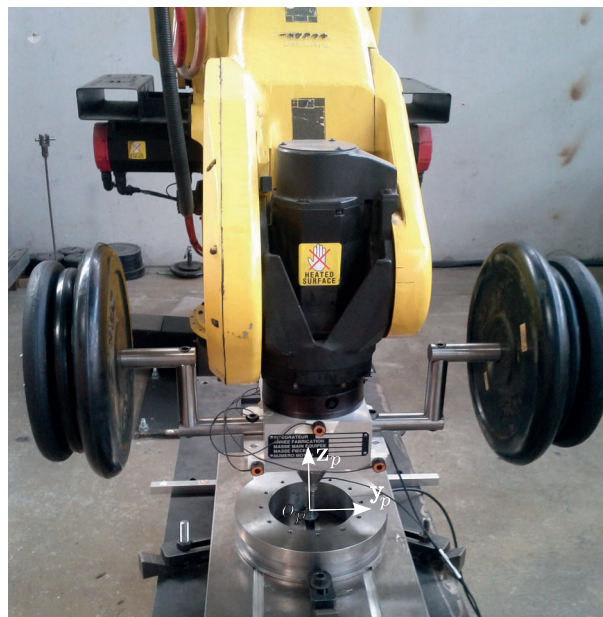
FIGURE 4.2 – Position du système de serrage par rapport au robot Fanuc S420iF
