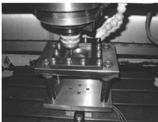
FIGURE 1.27 – Fraiseuse à commande numérique trois axes utilisée en ISF [Petek2009]
