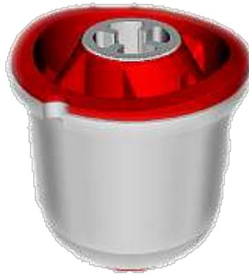
**Figure 1.2** – Cale élastique typique de châssis automobile.
