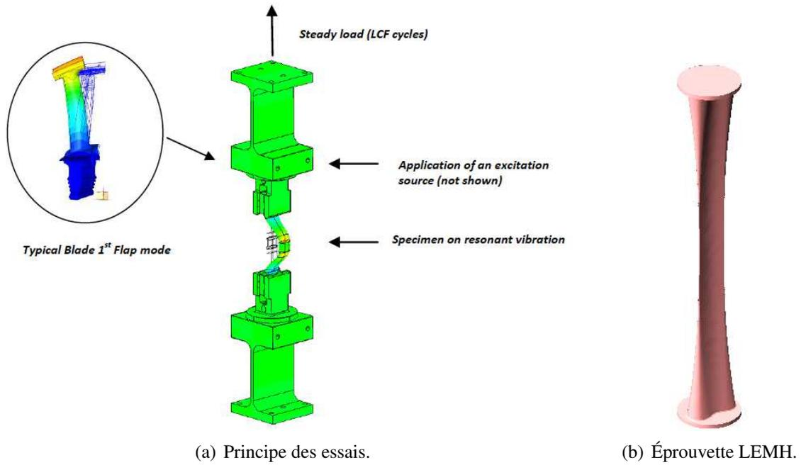
Figure 3.8 – Essais de fatigue CCF, d’après [PREMECCY 2012].
