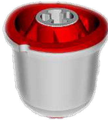
Figure 1.2 – Cale élastique typique de châssis automobile.
