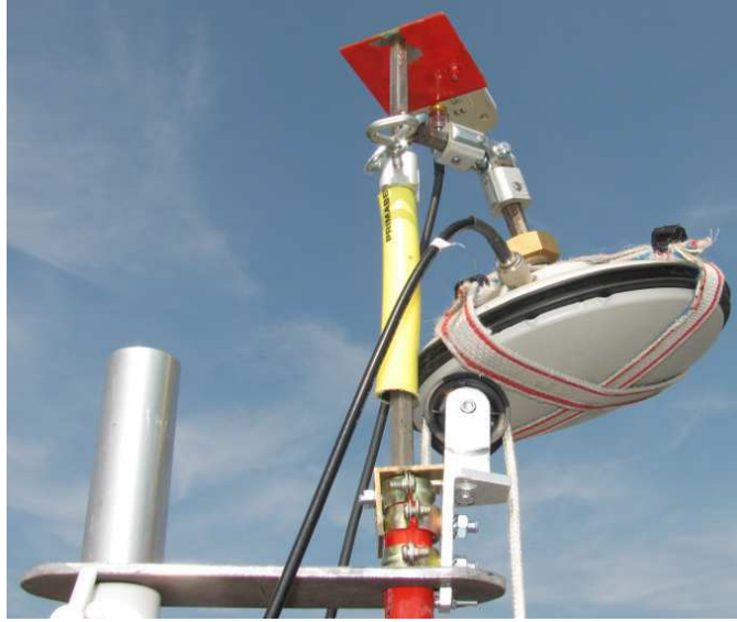
FIGURE 5.3 – Antennes réceptrices au sommet du mât
