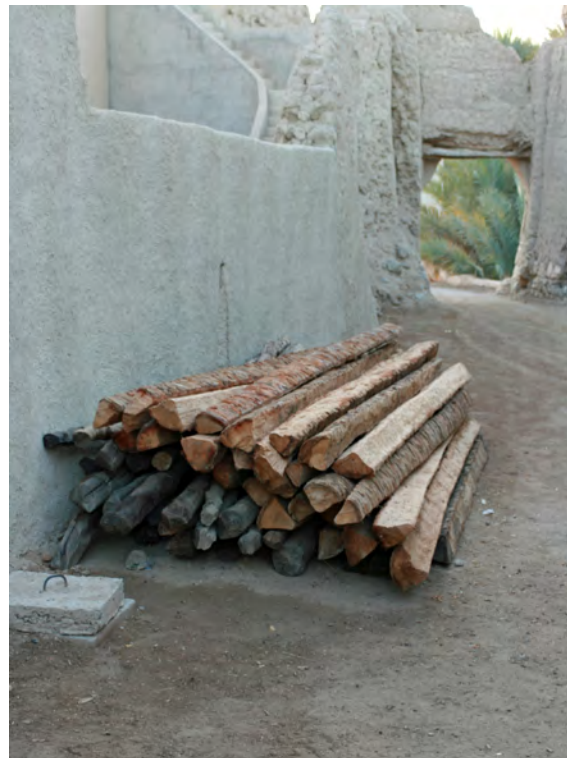
FIGURE 15.6 – Poutres réalisées à partir de stipes de palmiers. Photo : M. Tengberg.
