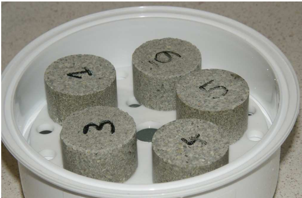
Figure II.1 Bouchons (ou plugs) de bentonite-sable de diamètre 36,7mm et 25mm de hauteur, juste après compactage.
