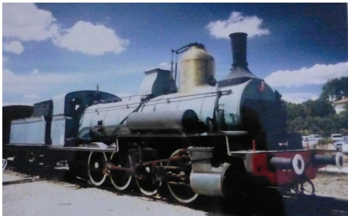
Photographie 28. Locomotive de type 040 des ateliers Beugnot utilisée sur la ligne du Rhône au Mont-Cenis (collection H. Billiez).
