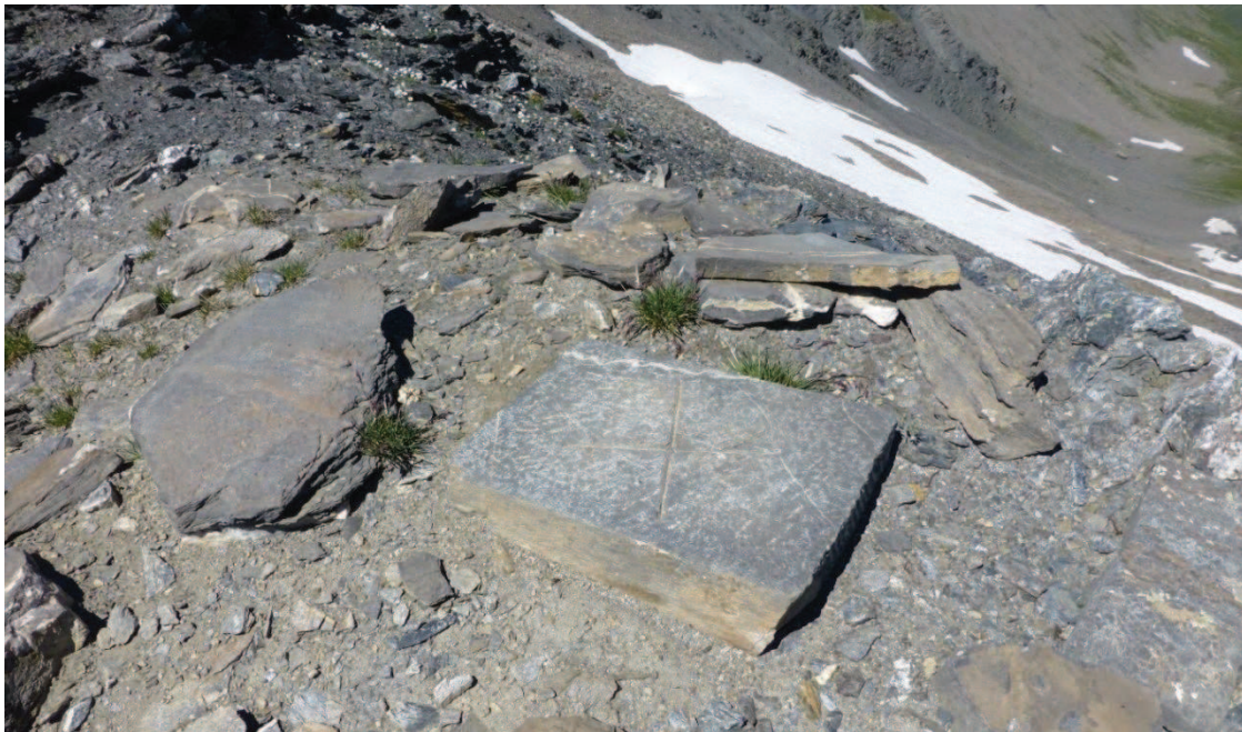
Photographie 3. Signal utilisé pour le positionnement du théodolite à l'intérieur de l'observatoire (K. Sutton, août 2013).
