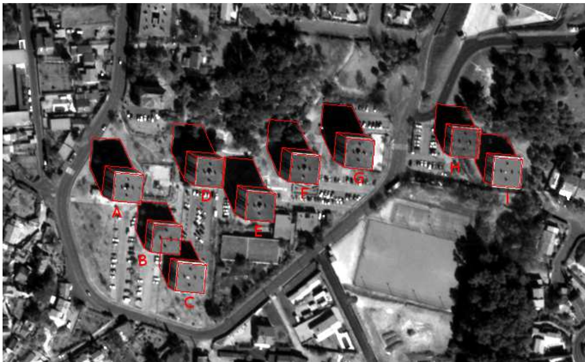
Figure 2.9 – Simulation de la signature géométrique de bâtiments dans une image QuickBird (©DigitalGlobe).
