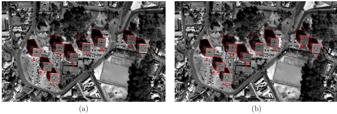
Figure 4.12 – Résultats de la stratégie d'estimation sur données réelles en imagerie optique : signatures géométriques des neuf bâtiments de la scène d'étude simulées à partir des valeurs estimées (a) et des valeurs vraies (b) des paramètres de ces bâtiments.
