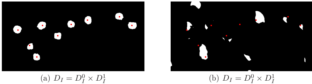
Figure 5.20 – Cartes binaires de détection D_I résultant du produit des cartes binaires de détection D_I^0 et D_I^1 des figures 5.18 et 5.19.
