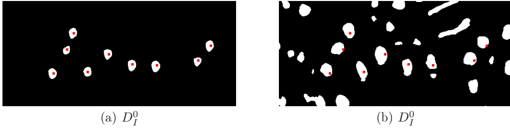
Figure 5.25 – Cartes binaires de détection D_I^0 établies à partir des images binaires de primitives B_I^0 simulée (a) et réelle (b) des figures 5.21 et 5.22.
