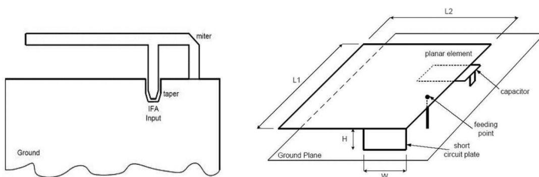
Figure 2.9 – Les motifs de l'antenne IFA et PIFA [2.9]
