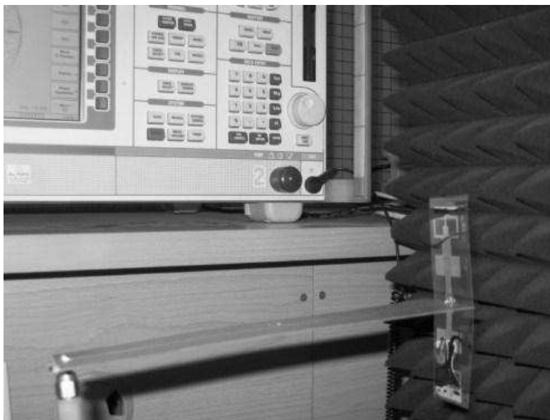
Figure 4.22 - Mesure de l'impédance des prototypes HO-01 avec l'Analyseur de Réseau Vectoriel ZVB8 de Rohde & Schwarz
