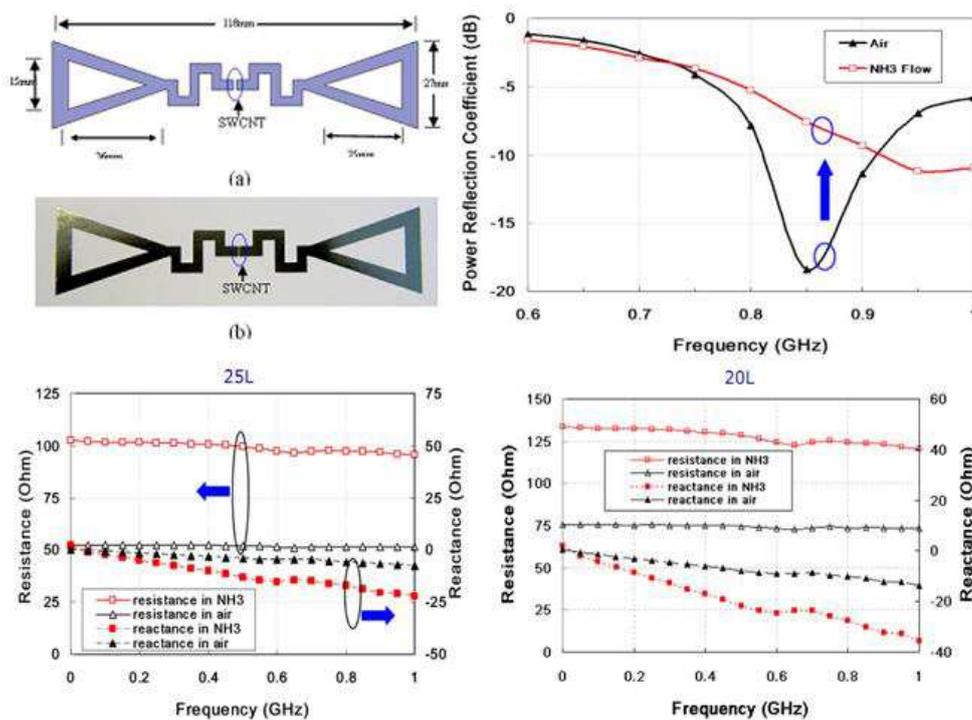
Figure 6.6 - Tag chipless pour la détection des gaz [6.21]
