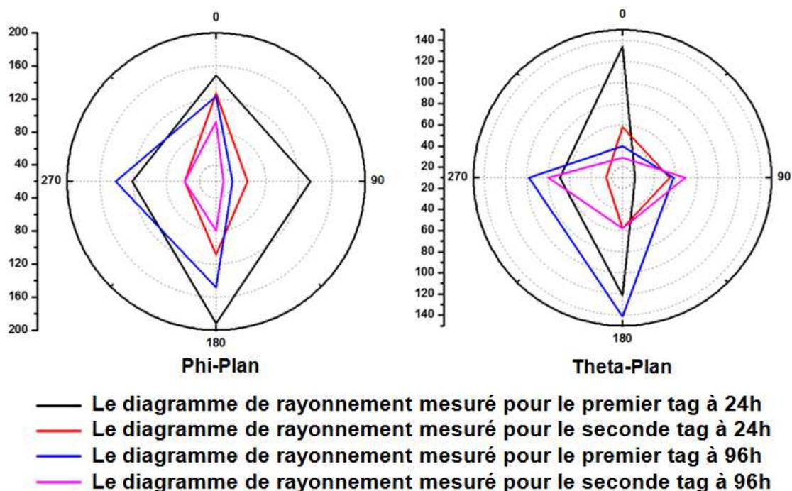
Figure 6.35 - Les diagrammes de rayonnement mesurés pour la conception To-1 sur Phi-Plan (à gauche) et Thêta-Plan (à droite)
