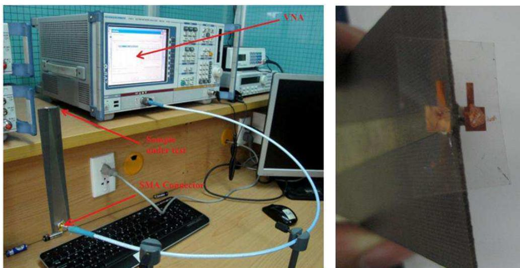
*Figure 2.31 - La mesure de l'impédance de la puce avec l'Analyseur de Réseau Vectoriel ZVB8*
