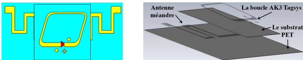
Figure 6.11 - Géométrie de l'antenne utilisée pour la simulation
