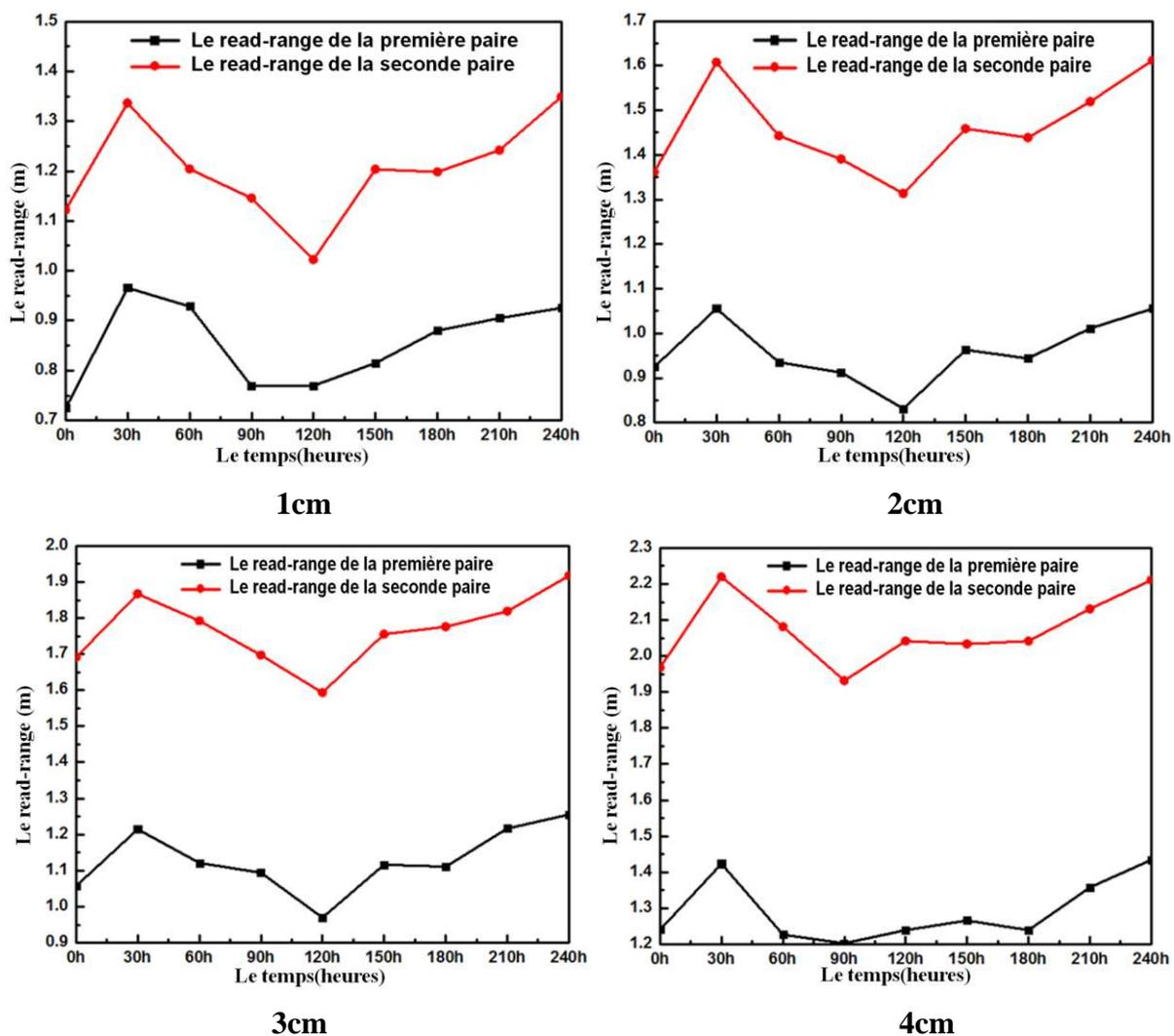
Figure 6.20 - Le read-range de chaque paire de l'antenne/puce mises ensemble sur l'échantillon du boeuf avec la distance d entre 1cm et 4cm
