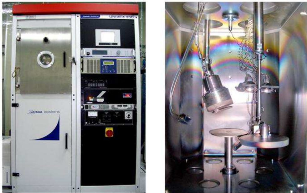
Figure 3.6 – Equipement de pulvérisation cathodique Leybold Univex 350 (à gauche) et intérieur de la chambre de pulvérisation (à droite)
