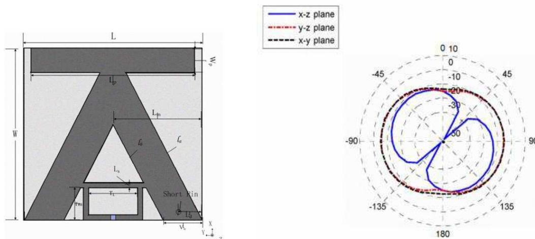
Figure 2.8 – Antenne microruban et son diagramme de rayonnement [2.8]
