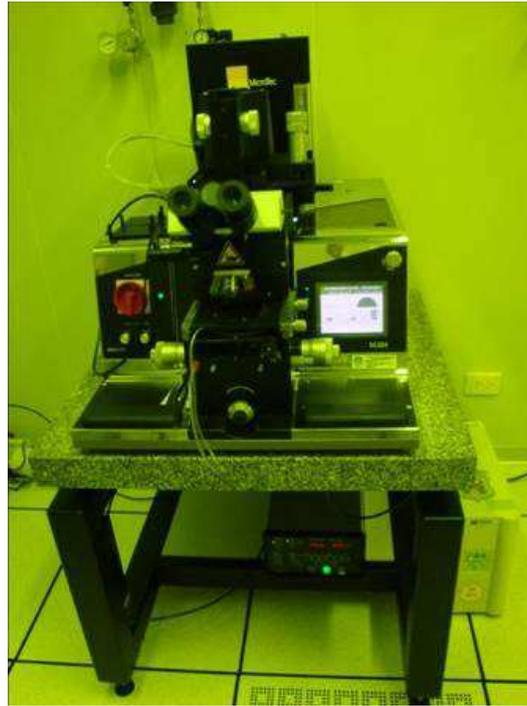
*Figure 3.4 – Equipement de photolithographie MJB-4 (Suss Microtec)*
