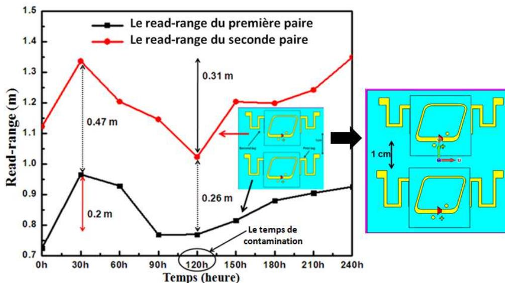
Figure 6.22 - La conception finale pour le tag capteur So-1 avec distance  $d = 1\text{cm}$
