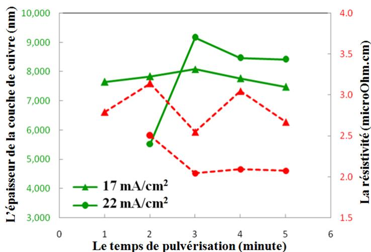
*Figure 4.19 – Épaisseur et résistivité de la couche pulvérisée à 100 W pour les densités de courant de 17 mA/cm<sup>2</sup> et 22 mA/cm<sup>2</sup>*
