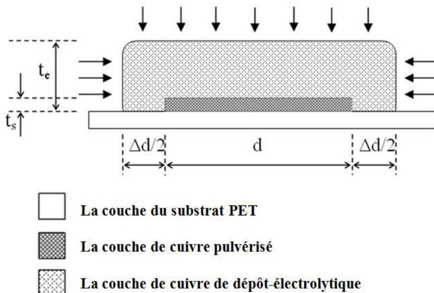
Figure 4.12 – Elargissement des motifs pendant le dépôt électrolytique
