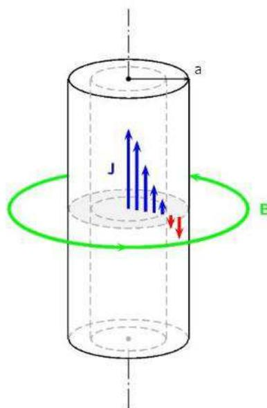
*Figure 4.20 - Modèle d'une ligne conductrice de forme cylindrique*
