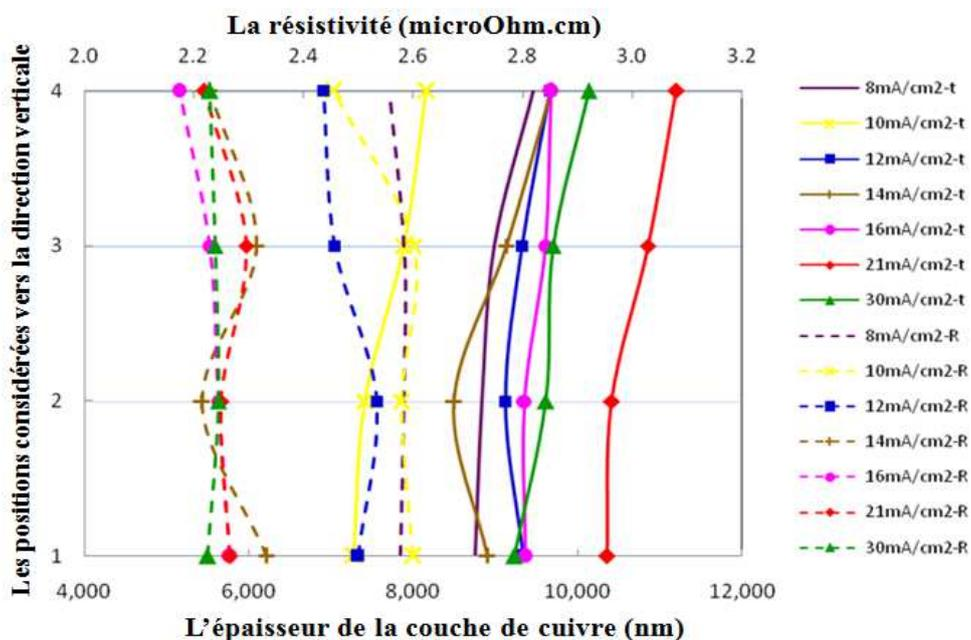
Figure 4.17 – Répartition de l'épaisseur et de la résistivité moyenne dans la direction verticale de l'échantillon
