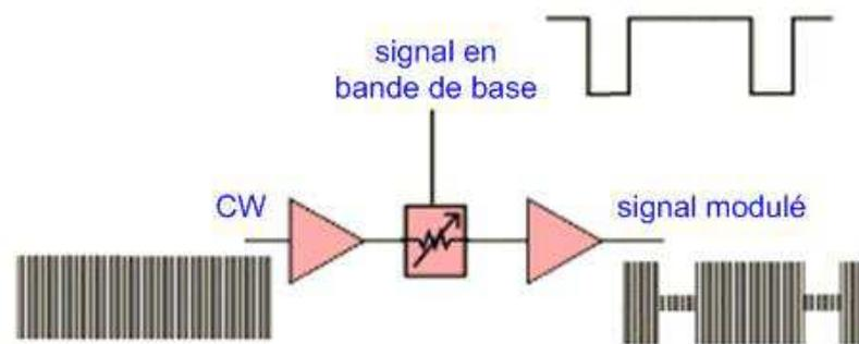
*Figure 1.15 - Modulation type ASK dans un lecteur RFID [1.3]*
