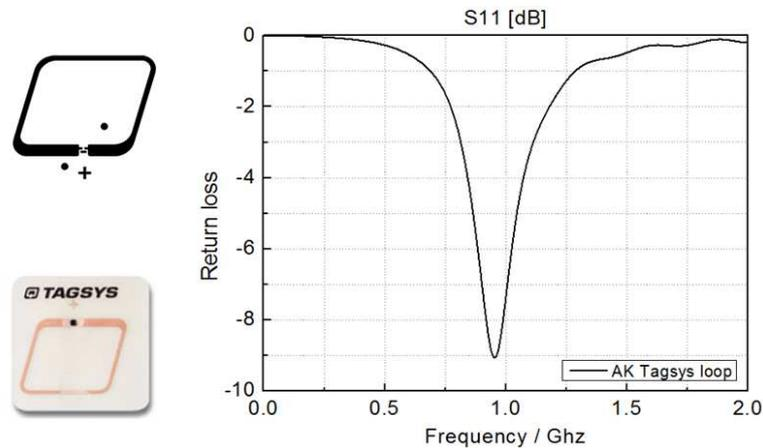
*Figure 2.21 - La boucle AK3 Tagsys et son coefficient de réflexion*
