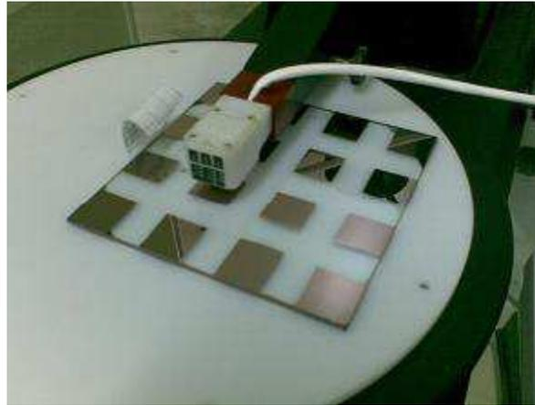
*Figure 3.9 – Echantillon pulvérisé pour l'étude de la qualité du dépôt métallique*
