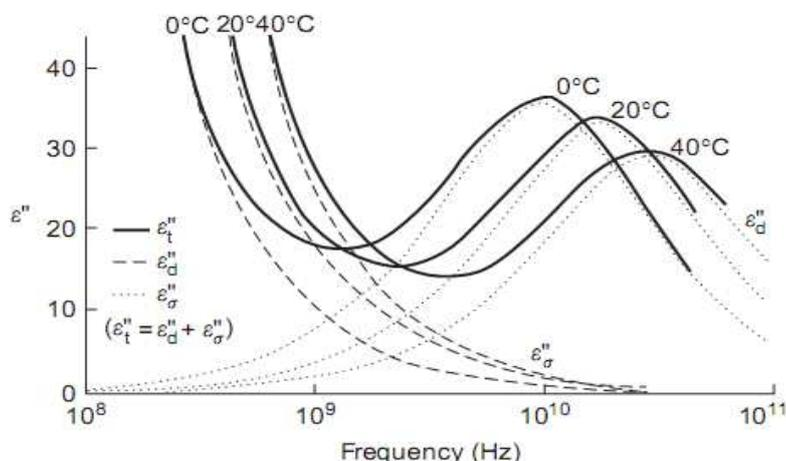
Figure 5.4 – Effet de la température sur le facteur de perte diélectrique de NaCl à 3 températures différentes [5.5]
