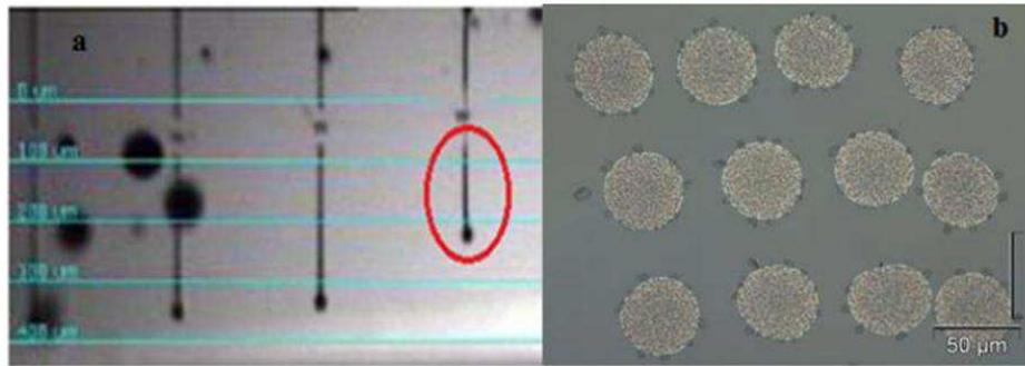
*Figure 4.10 - Lignes d'impression inadéquates dues à des vitesses inappropriées*
