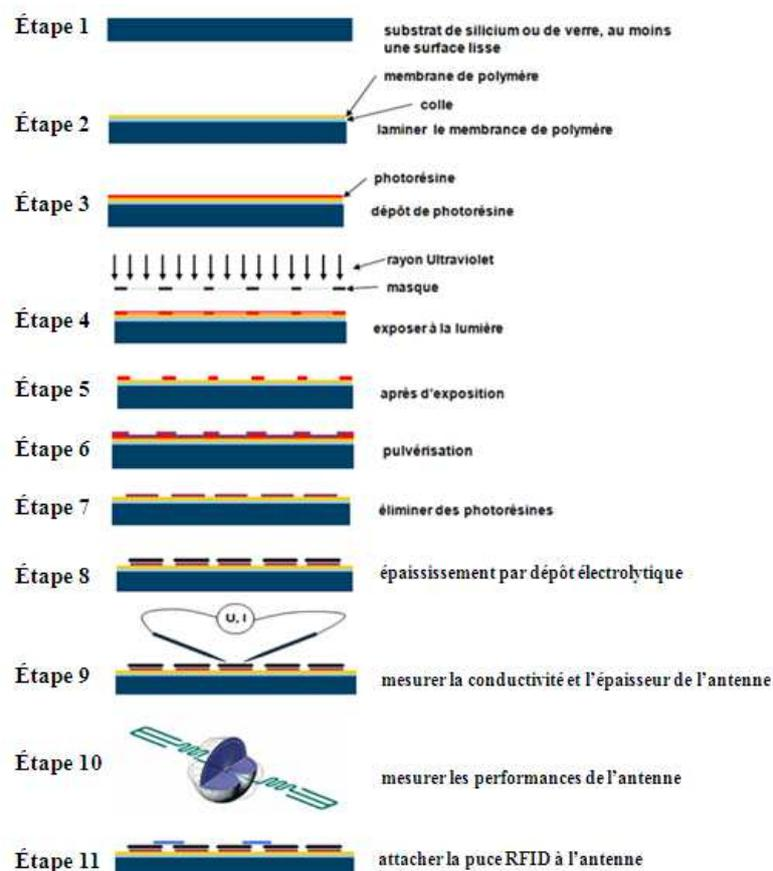
Figure 4.1 - Etapes de fabrication au Laboratoire de NanoTechnologie (Vietnam)
