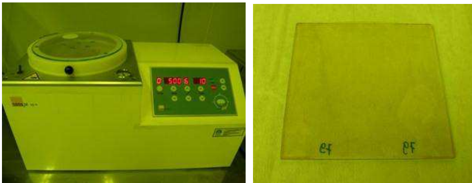
Figure 3.3 – Le dispositif de spinner SUSS Microtec/ DELATA 6RC et l'échantillon après la couverture de LOR/Photosensible
