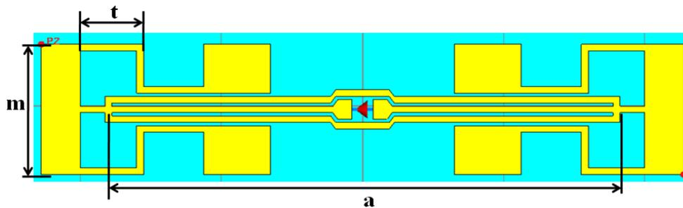
*Figure 4.21 – Géométrie de l'antenne de l'étiquette HO-01*
