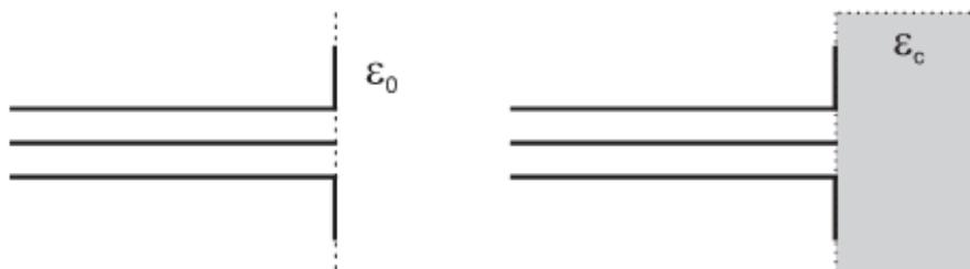
*Figure 5.11 - La sonde coaxiale dans le vide et en contact avec l'échantillon de mesure*
