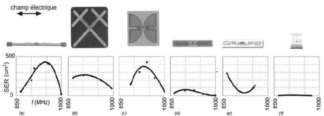
Figure 2.5 - SER mesurées de tags commerciaux [2.3]
