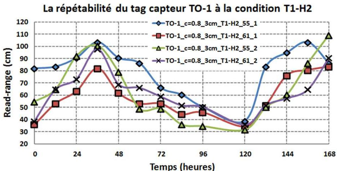
Figure 6.39 - Étude de la répétabilité du tag capteur TO-1 à la condition de stockage T1-H2 (dont la température de  $3\pm 1^{\circ}\text{C}$  et l'humidité de  $80\pm 5\%$ )
