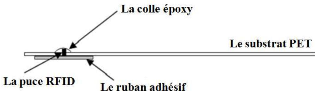
*Figure 4.25 - Connexion de la puce avec l'antenne*
