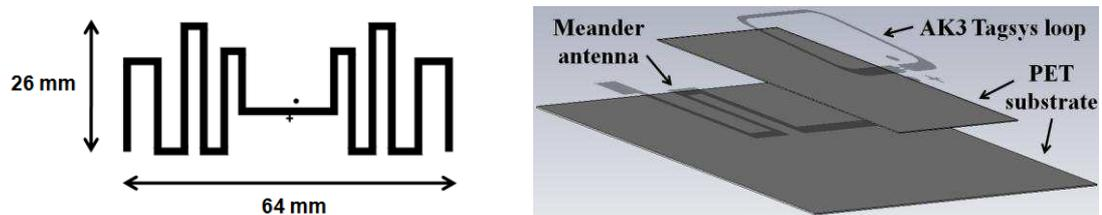
Figure 2.22. Le prototype SO-05 optimisé et la géométrie du tag final
