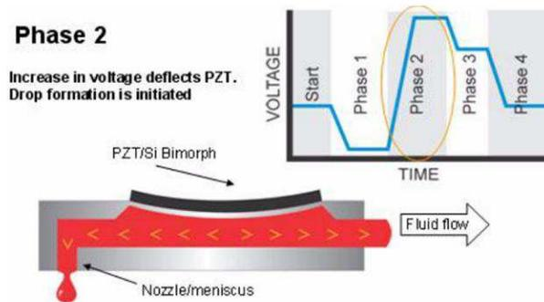
*Figure 3.17 - L'encre est poussée hors du canal [3.14]*
