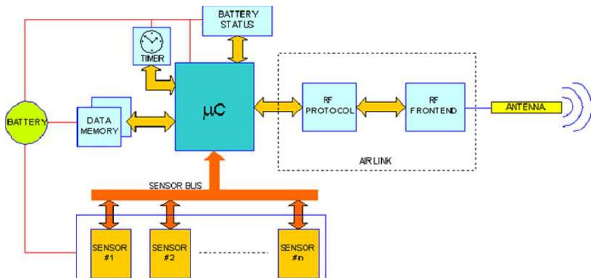
Figure 6.5 - Schéma bloc d'un tag capteur RFID actif
