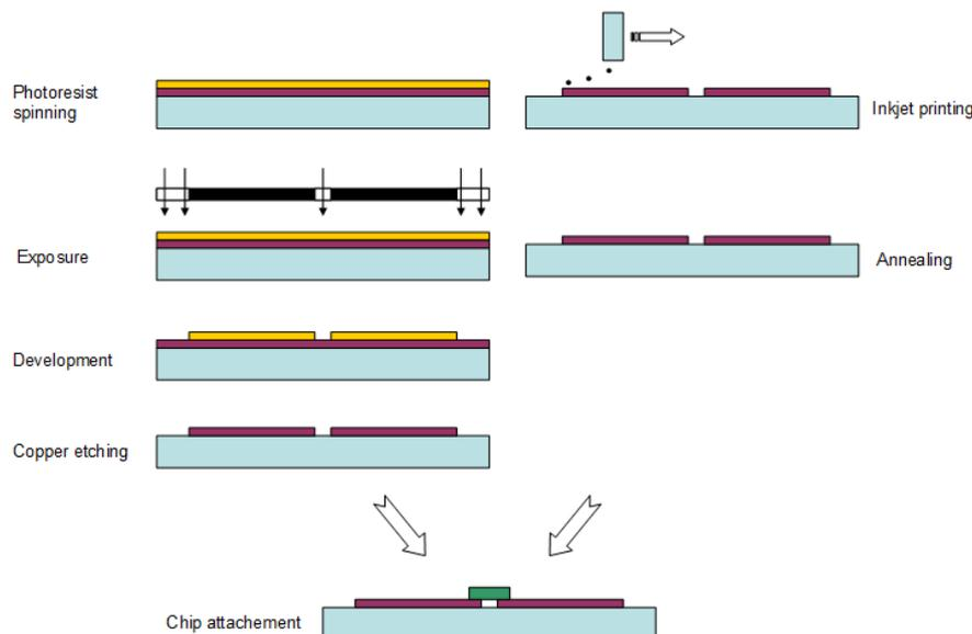
*Figure 3.11 – Procédé jet d'encre (à droite) par rapport au procédé de fabrication par technologie microélectronique standard (à gauche)*
