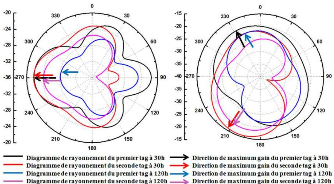
Figure 6.27 - Les diagrammes de rayonnement de la conception To-1 sur Phi-Plan (à gauche) et Thêta-Plan (à droite)
