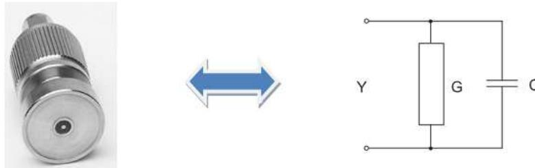
*Figure 5.10 - Le circuit équivalent de la sonde coaxiale*
