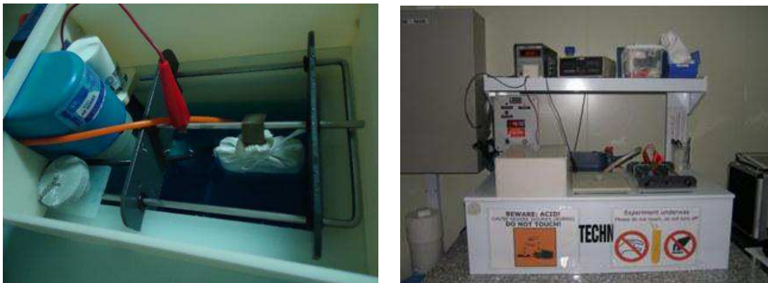
Figure 3.8 – Banc Technic pour le dépôt électrolytique de l'antenne
