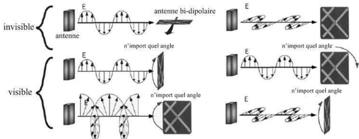
Figure 2.4 - Les tags bi-dipolaires multi-polarisation [2.3]
