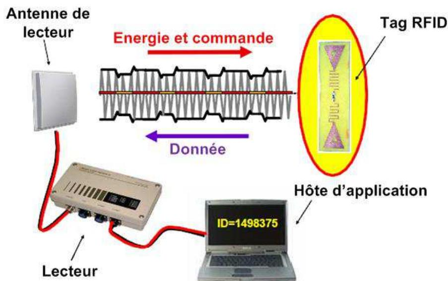
Figure 1.13 - Éléments d'un système RFID [1.2]
