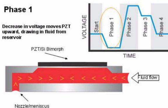
*Figure 3.16 - L'encre est injectée depuis le réservoir* [3.14]
