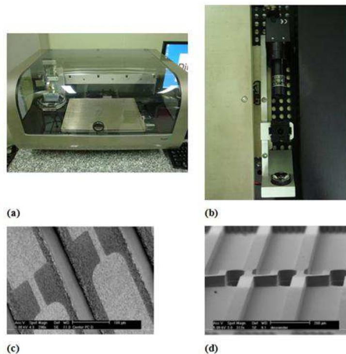
*Figure 3.14 – (a) Imprimante pour matériaux Dimatix      (b) Cartouche d'impression*
