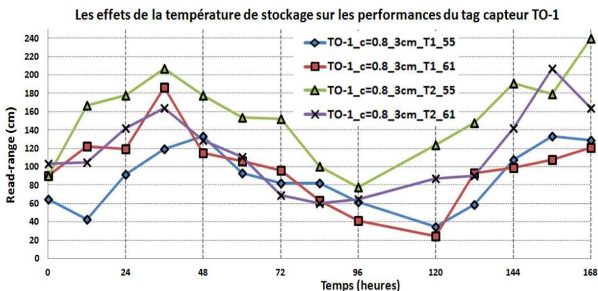
*Figure 6.40 - Étude des effets de la température de stockage sur les performances du tag capteur TO-1 (dont  $T1=2\pm 1^{\circ}\text{C}$  et  $T2=8\pm 1^{\circ}\text{C}$ , l'humidité est fixée à  $50\pm 5\%$ )*
