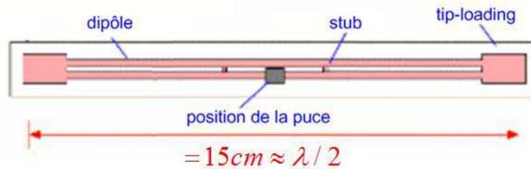
Figure 2.20 - Dipôle repilé avec des structures d'adaptation d'impédance [2.3]
