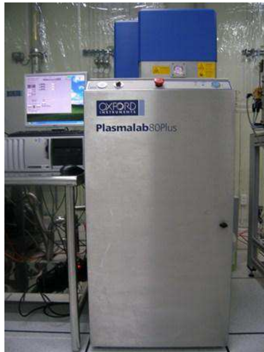
Figure 3.2 – Equipement de gravure par ions réactifs Plasmalab80 +
