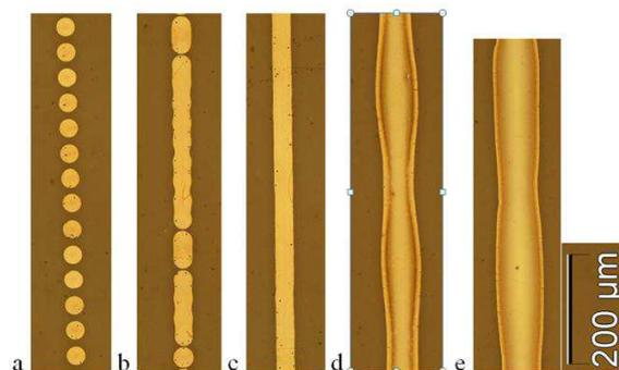
*Figure 3.20 – Lignes imprimées à différentes résolutions*
