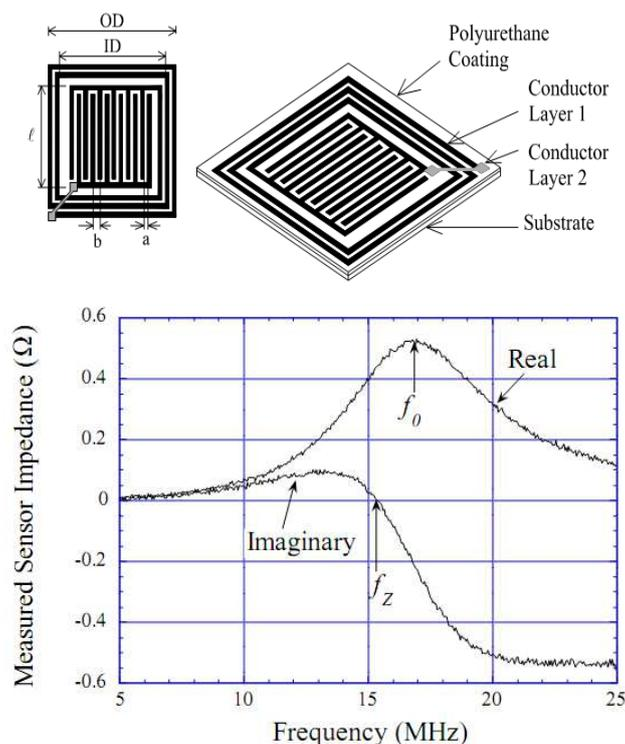
Figure 6.3 – Parties réelle et imaginaire de l'impédance et la géométrie du capteur [6.1]
