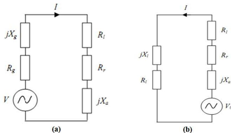
Figure 2.1 - Schémas équivalents d'une antenne en:
