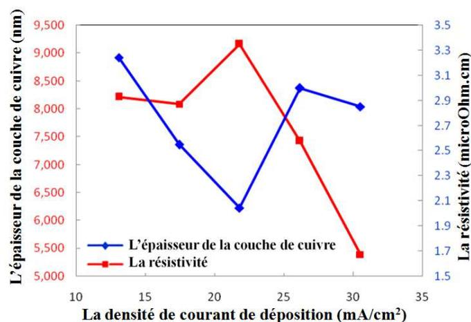
*Figure 4.18 – Epaisseur et résistivité de la couche pulvérisée à 100 W pendant 3 minutes suivi d'un dépôt électrolytique dans la solution  $S_1$*
