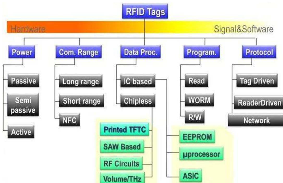
Figure 1.17 - Le classement des tags RFID [1.2]
