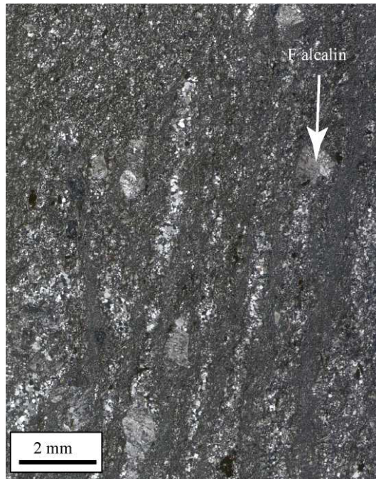
Figure IV.45. Microphotographie montrant la fluidalité magmatique dans les rhyolites du bassin de Idaho-Mahou. Observer l'orientation des phénocristaux de feldspaths et le rubanement de la matrice des phénocristaux. Les niveaux clairs sont formés de petits cristaux de quartz et de feldspaths et les niveaux sombres, du fond microcristallin.
