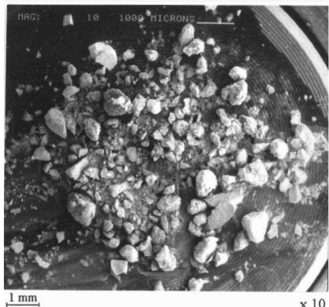
Figure .4.8. Pastille composite UO_2 - Gd_2O_3 délitée suite au test en autoclave [Balestrieri, 1995].
