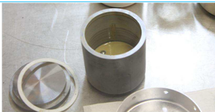
Figure .1.11. Barbotine C1 après cobroyage avec éthanol dans conteneur en tungstène.
