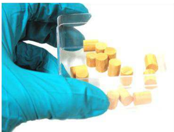
Figure .3.2. Pastilles de Gd_6UO_{12} (Laboratoire-UO 2 - Cadarache) obtenues lors de cette thèse.
