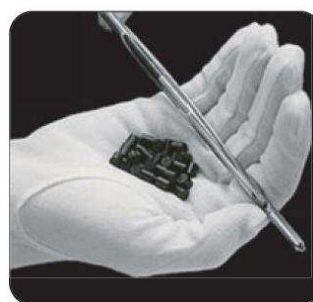
Figure .2.5. Pastilles d'oxydes d'uranium, [Blanpain, 2011]
