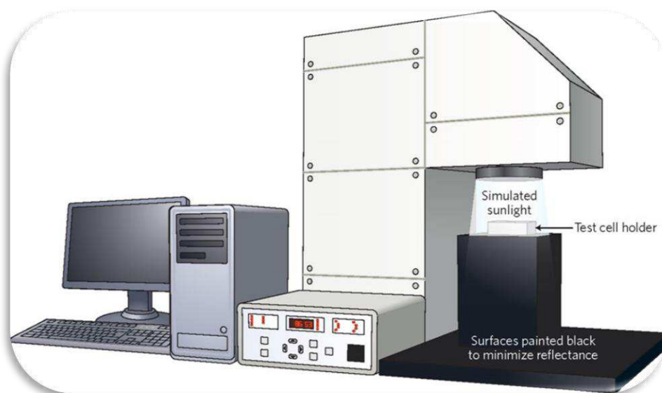
Figure III.21 : Représentation d'un simulateur solaire et de l'installation nécessaire aux mesures photovoltaïques [19]
