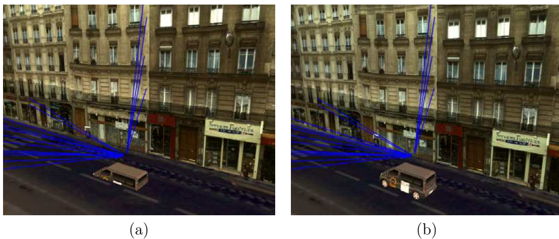
FIGURE 8.5 – Illustration de la procédure de relèvement. (a) Avant le processus, le véhicule est "en dessous" de la chaussée. (b) Après le processus, le véhicule est sur la chaussée. Le modèle 3D présent sur l'illustration n'est là que pour aider à la compréhension (précision décimétrique). Le véhicule est à l'échelle du modèle.
