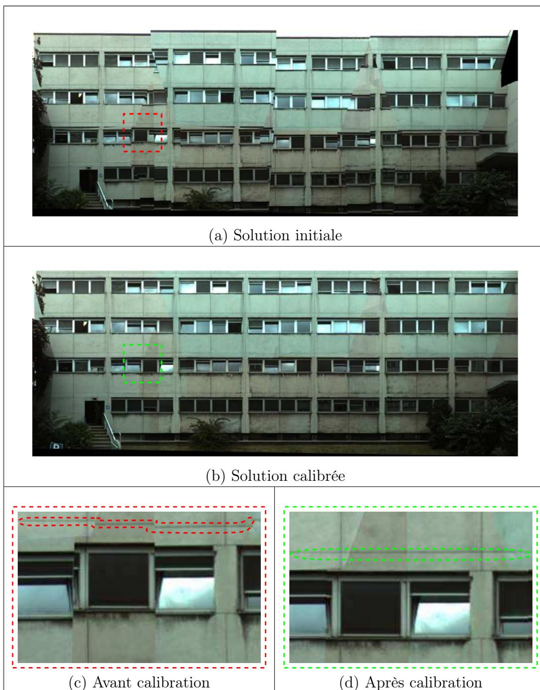
FIGURE 4.8 – Comparaison de la texturation des façades des batiments avec les images du véhicule sans tenir et en tenant compte de la calibration.
