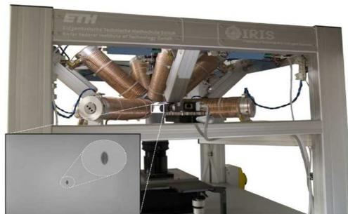
Figure I.13 – Le prototype d'EMA OctoMag proposé par [72].
