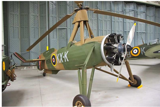
Figure 1.9: Cierva C30A, l'un des premiers autogires illustrant la présence d'un rotor libre et d'une hélice dédiée à la propulsion.
