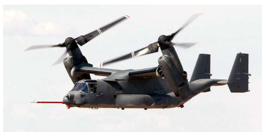
Figure 1.12: Photographie d'un V22 Osprey dont les nacelles sont en cours de basculement.
