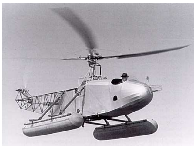
Figure 1.2: Le VS 300 est le premier appareil proposant un rotor anticouple en plus du rotor principal. Il s'agit véritablement du premier hélicoptère.
