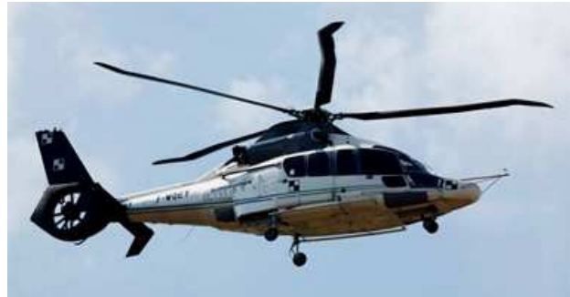
(b) Photographie de l'EC 155 équipé de pales Blue Edge™.
