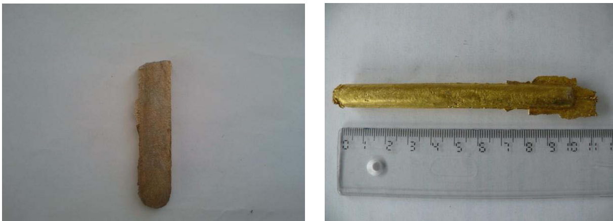
Figura 4.7 Probe turnate în forma paralelipipedică și cilindrică, în stare brută
