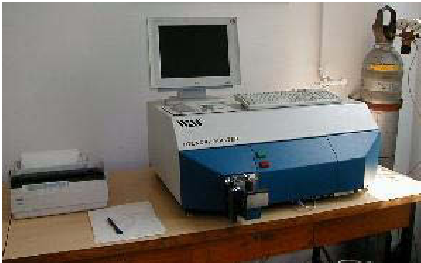
Figura 3.1. Spectrofotometrul Foundry Master utilizat pentru determinarea compoziției chimice a AMF studiate
