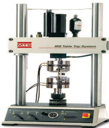
Figura 3.5 Mașina de tracțiune MTS \pm 15 kN utilizată pentru testele mecanice din teză
