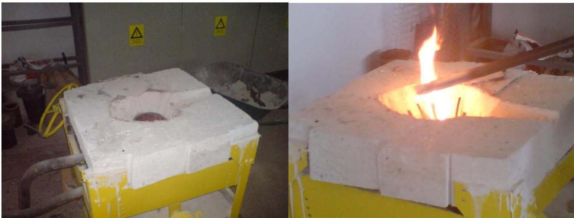
Figura 1.11 Elaborarea aliajului cu memoria formei pe bază de cupru-zinc-aluminiu a) cuptor în starea inițială a topirii și b) arderea cu flacără a zincului[51]
