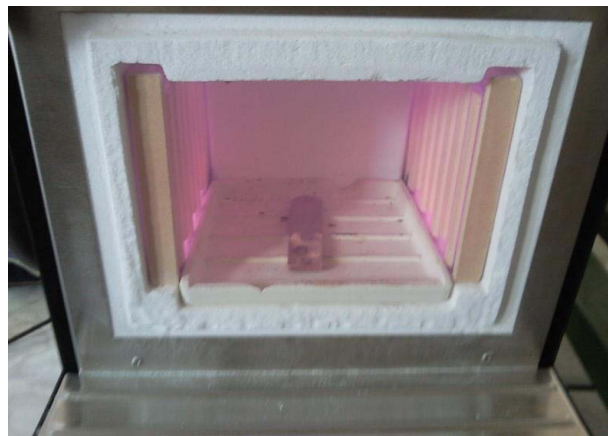
Figura 5.4. Eșantionul de AMF în timpul procesului de încălzire premergător laminării
