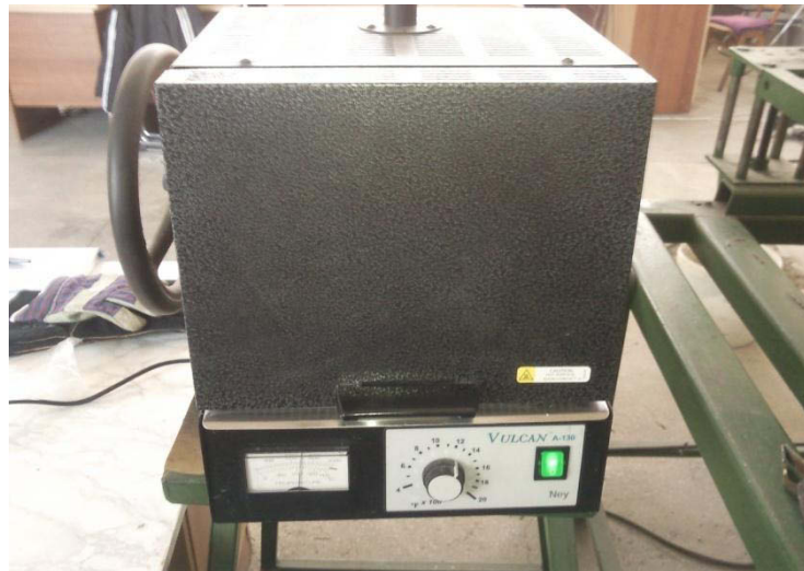
Figura 5.3 Cuptorul electric cu rezistență Vulcan A 130 folosit pentru încălzirea probelor laminate
