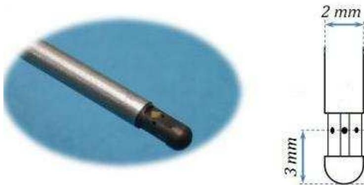
FIGURE 2.11 – Photo et schéma de la sonde 3 trous
