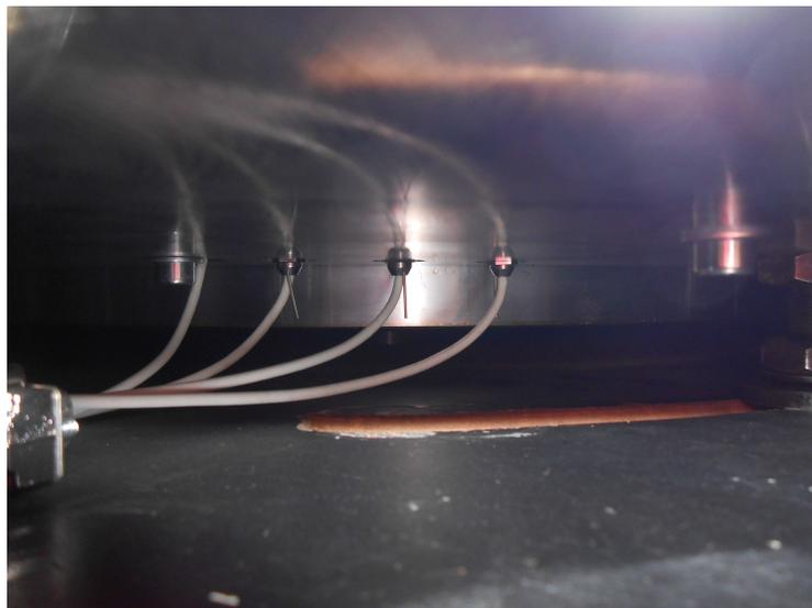
FIGURE 2.25 – Montage des capteurs instationnaires sur le moyeu
