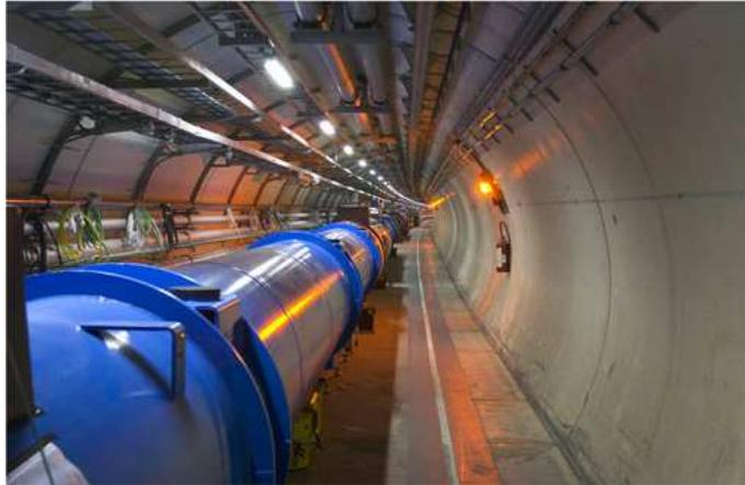
FIG. 3.3– Un des 1232 aimants dipolaires du LHC incurvant la trajectoire des particules.
