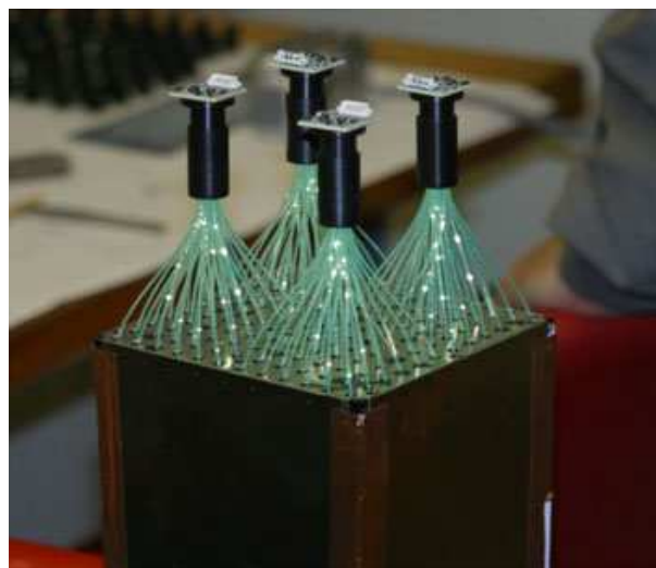
FIG. 4.6– Un module du calorimètre EMCal. Les quatre tours, constituées d'un empilement de couches de plomb et de scintillateur, sont traversées par des fibres optiques conduisant la lumière de scintillation jusqu'à une photo-diode à avalanche.
