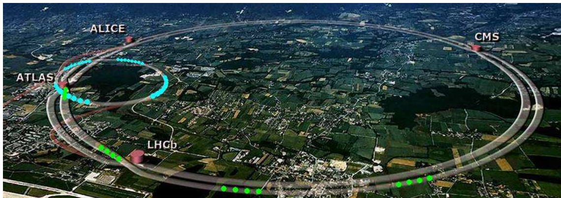
FIG. 3.1– Le grand collisionneur de hadrons du CERN situé de part et d'autre de la frontière franco-suisse. Son tunnel de 27 km de circonférence est représenté par le grand cercle, le cercle plus petit représente l'anneau du SpS qui fait partie de sa chaîne d'injection.
