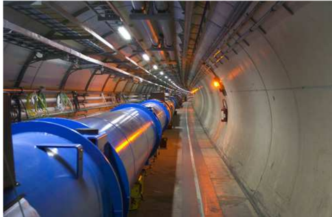
FIG. 3.3– Un des 1232 aimants dipolaires du LHC incurvant la trajectoire des particules.
