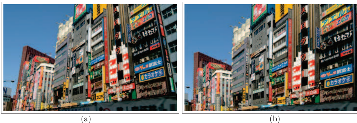
FIGURE 2.1 – Exemple de déformation d'image corrigeant la distorsion optique d'un objectif. (a) Photographie initiale présentant une distorsion de la perspective suite à l'usage d'un objectif grand angle. (b) Photographie corrigée par une technique d' image warping .
