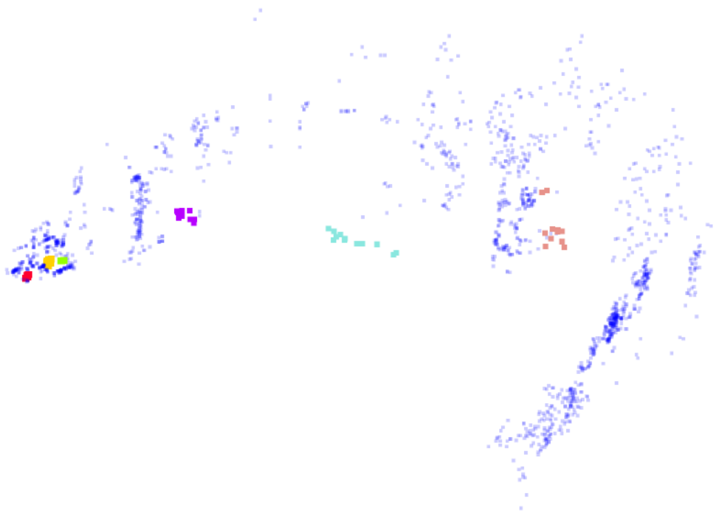
FIGURE 3.13 – Expérience « Hall » : Nuage de points 3D de la structure statique (en bleu) et modèles géométriques des objets détectés (différentes couleurs).
