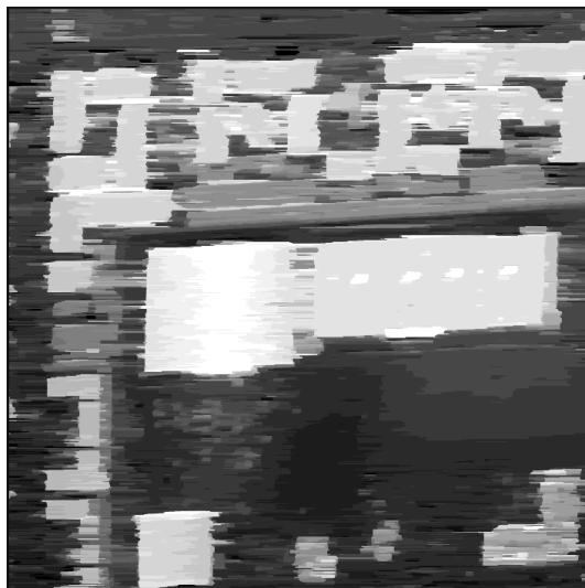
FIGURE 2.6 – Illustration d'un effet de streaking le long des lignes d'une image traitée par programmation dynamique.
