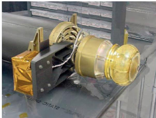
FIGURE 2.4.: Instrument SWEA installé au bout du mât et le magnétomètre sur la tablette raccordé à ce dernier. Lorsque le mât est déployé, les deux instruments sont séparés d'une distance d'un mètre. Photographie tirée de Sauvaud et al. [2008].
