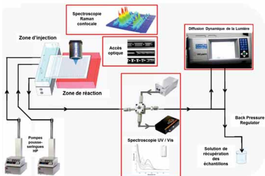
Figure A-6. Montage expérimental en microfluidique supercritique développé à l'ICMCB. Microréacteurs HP/HT (Si-Pyrex) couplés avec techniques de caractérisation in situ et en ligne [41].
