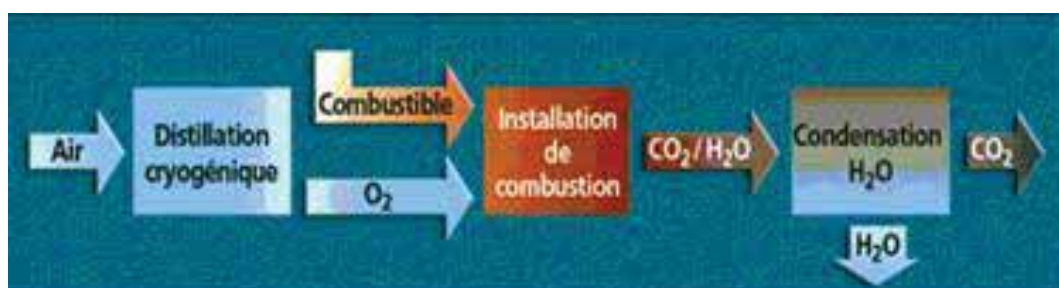
Figure A-18. Schéma simplifié de la technologie d'oxy-combustion.
