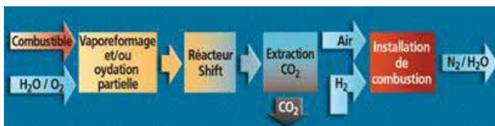
Figure A-17. Schéma d'un procédé pré-combustion de capture du \text{CO}_2
