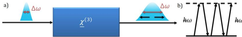
FIGURE 1.46: a) Schéma de principe de la SPM montrant l'élargissement spectral d'une impulsion lumineuse traversant un matériau non linéaire. b) Diagramme quantique de la SPM.
