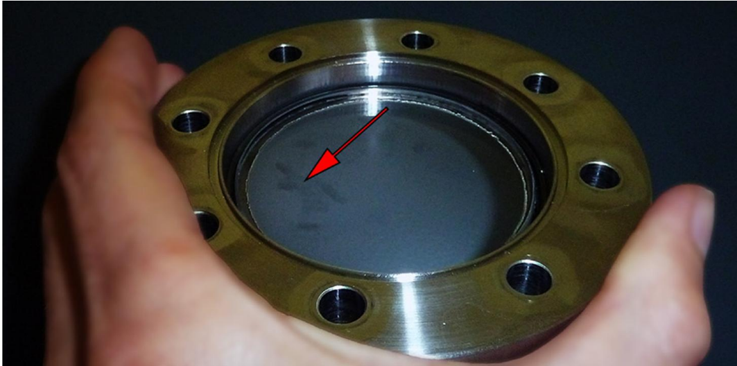
Figure III-13. Dépôts de particules lors de l'ablation. Sur cette photographie, la zone de dépôt est de couleur gris claire ce qui contraste bien avec la zone indiquée par la flèche rouge, plus foncée, où passait le faisceau laser lors des différents spots d'ablation et où le dépôt est moindre.
