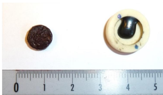
Figure III-32. Comparaison entre deux standards AGV2. A gauche, l'échantillon a été fondu dans le four à moufle et à droite il a fondu dans le four sous argon.
