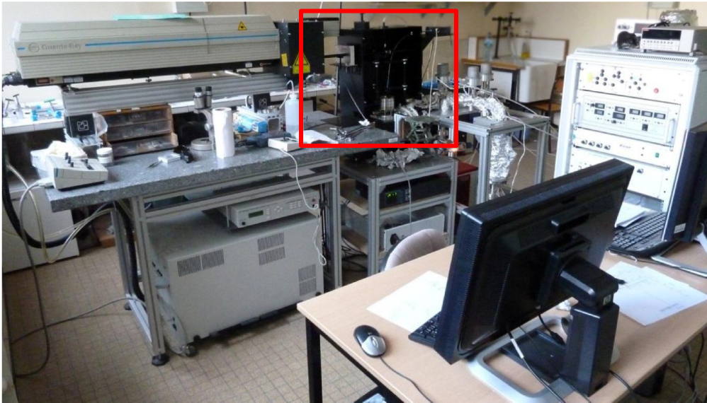
Figure III-11. Vue globale de l'expérience. Encadré en rouge, la partie LIBS.
