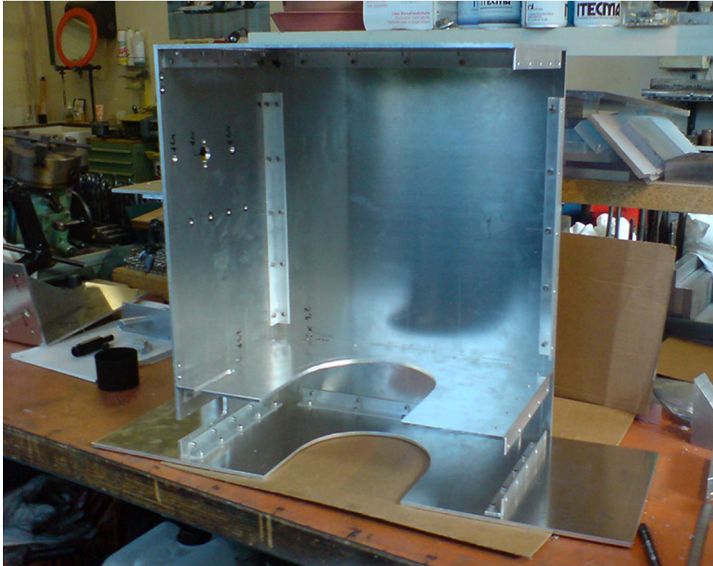
Figure III-9. Premier montage de la structure
