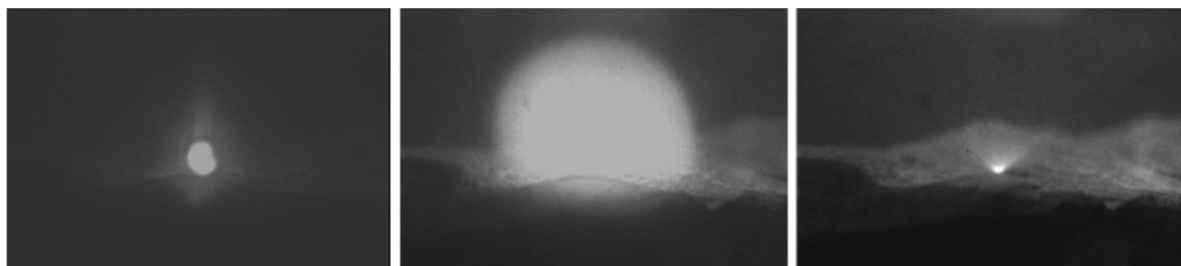
Figure VI-12. Plasma de basalte sous différentes pressions. A gauche à 585 torr, au centre 7 torr (pression martienne) et 0,00012 torr à droite. La luminosité des photos du centre et de droite ont été rehaussées par un gain d'un facteur 7. L'acquisition a duré 80 ms et a été déclenché 2 \mu\text{s} après le pulse. Extrait de Singh & Thaku, 2007.
