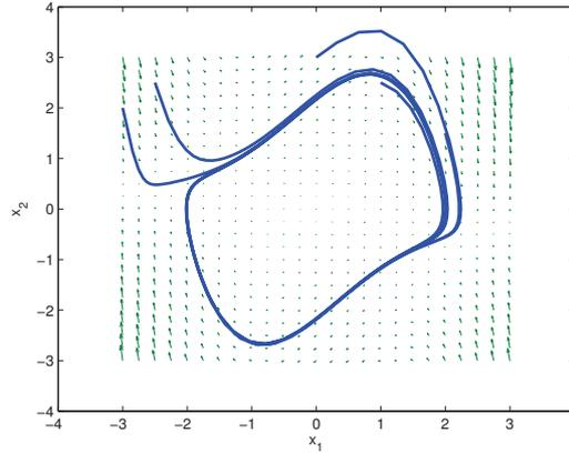
FIGURE 9.1 – Quelques trajectoires du système  $S$  montrant l'existence d'un cycle limite.
