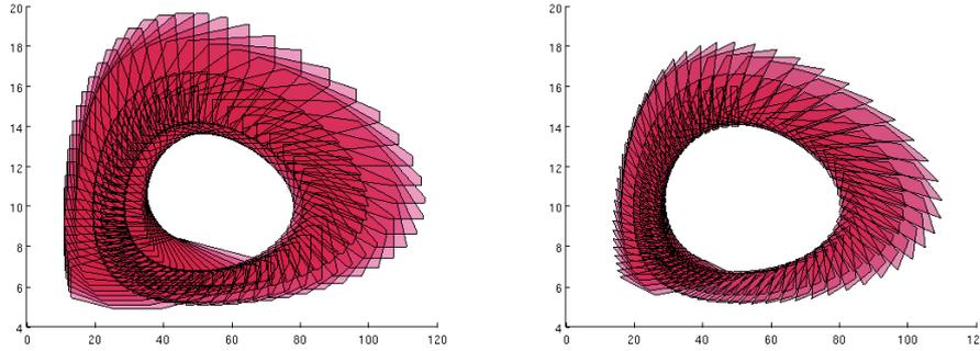
FIGURE 6.7 – Calcul de l'ensemble atteignable pour le modèle proie-prédateur en 2 dimensions en utilisant un modèle dynamique pour le polytope  $\bar{X}_k$  avec boîtes alignées avec les axes (statiques) à gauche et des boîtes orientées (dynamiques) à droite.
