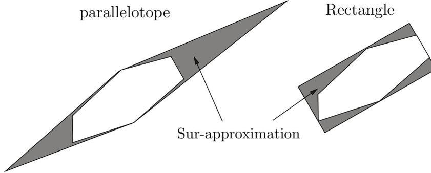
FIGURE 6.2 – Avantage de l'utilisation des boîtes orientées.
