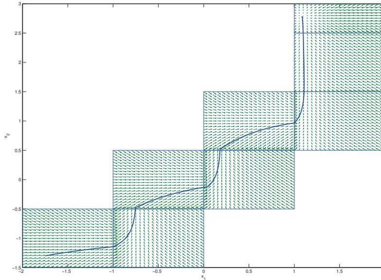
FIGURE 9.9 – Les champs de vecteurs du système (9.17) dans les rectangles  $R_1, \dots, R_8$  associés respectivement aux contrôleurs  $u_1, \dots, u_8$  ainsi qu'une trajectoire illustrant la planification.
