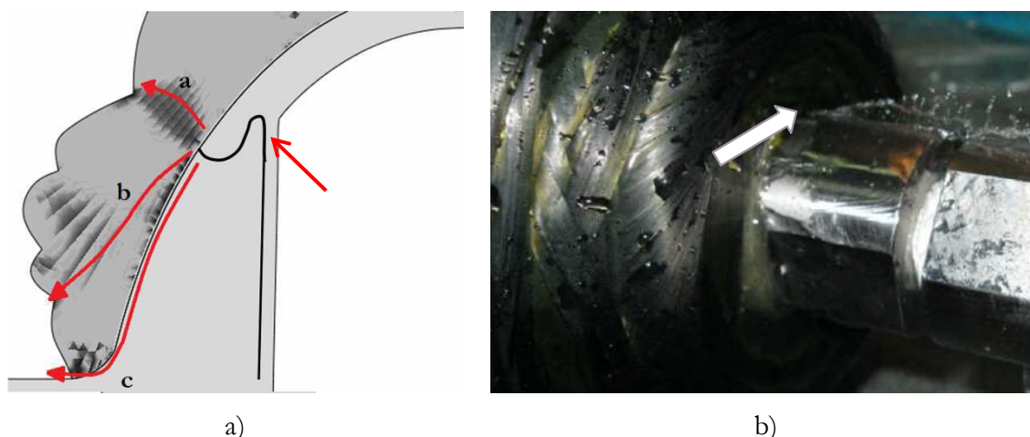
Figure 161. a) Détail de l'endommagement hors - plan et b) fuite détectée lors des essais.
