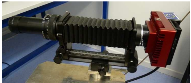
Figure 81. Camera utilisée pour la corrélation d'image.
