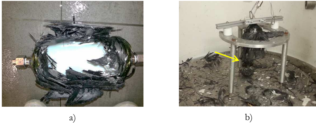
Figure 154. a) Réservoir éclaté en mode sain et b) non sain.
