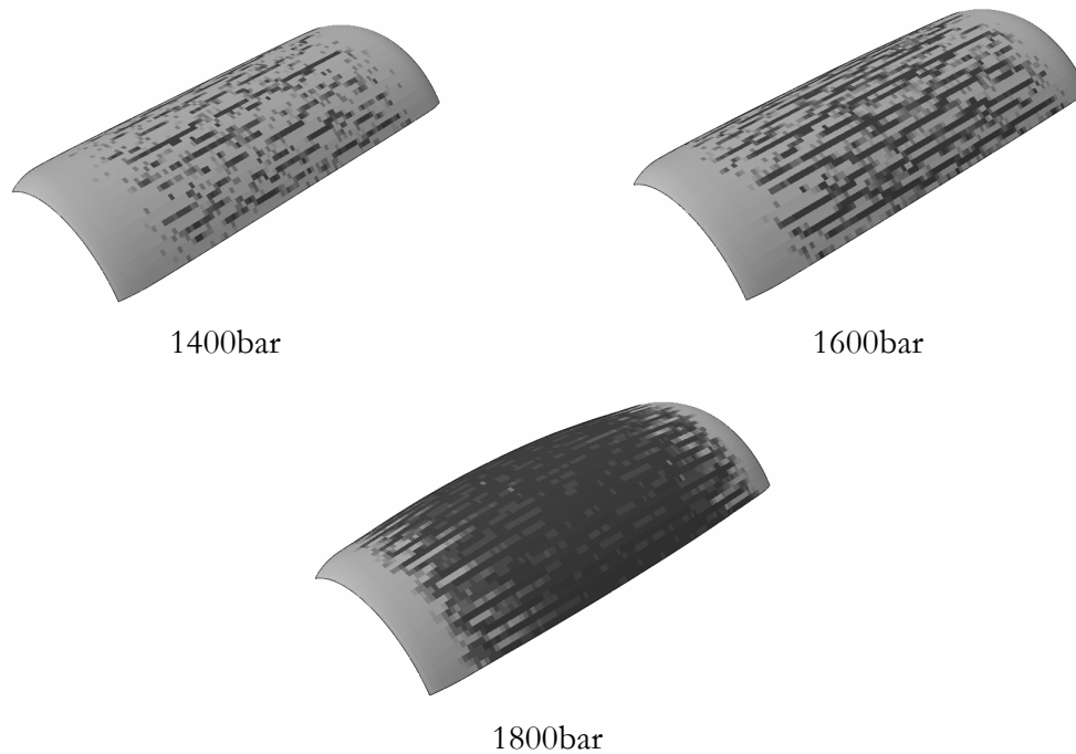
Figure 166. Endommagement des fibres de la première couche circonférentielle -simulation probabiliste 3D (noir : fibre rompue).
