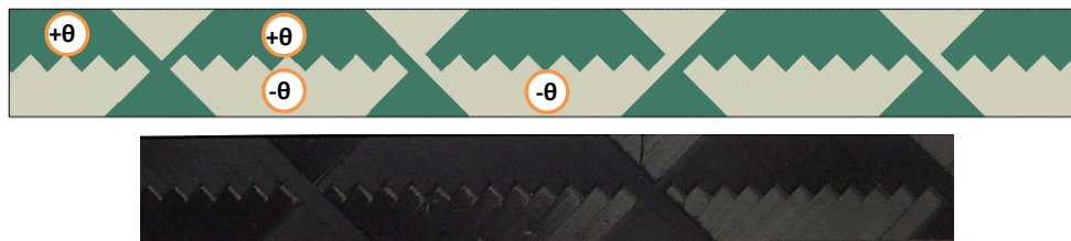
Figure 62. Eprouvette EF [\pm 45_4]_s et éprouvette réelle.
