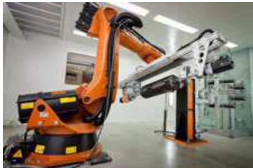
Figure 142. Fabrication du réservoir bobiné de type IV.
