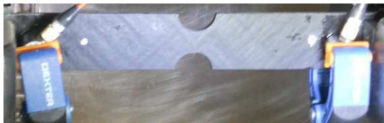
Figure 79. Dispositif expérimental des essais de traction.
