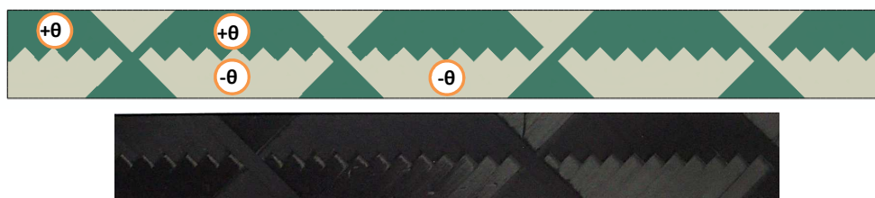
Figure 62. Eprouvette EF [\pm 45_4]_s et éprouvette réelle.
