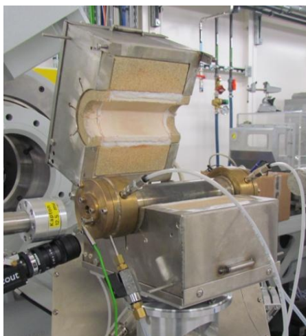
Figure II.16 : Four EXAFS ouvert et son tube en inconel contenant la cellule EXAFS
