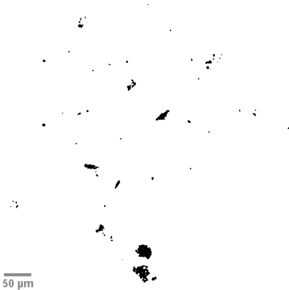
Figure 158 : Exemple d'image binarisée pour ne prendre en compte que les amas de platinoïdes (ne correspond pas à la Figure 1588).
