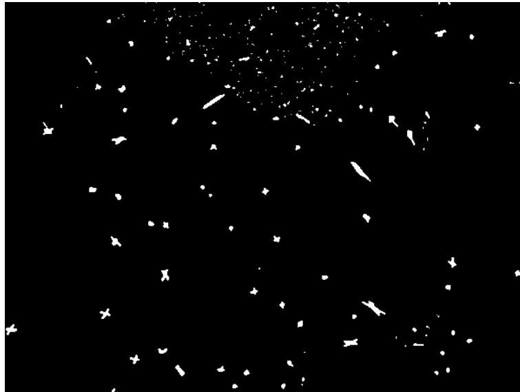
Figure 78 : Image binaire à l'issue de l'application du filtre median
