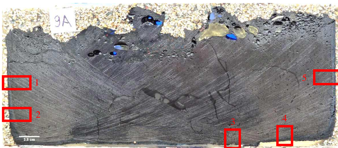
Figure 141 : Tranche de verre issu de l'essai sur PEV de 65 h (les rectangles rouges correspondent aux échantillons d'auto-creuset prélevés).
