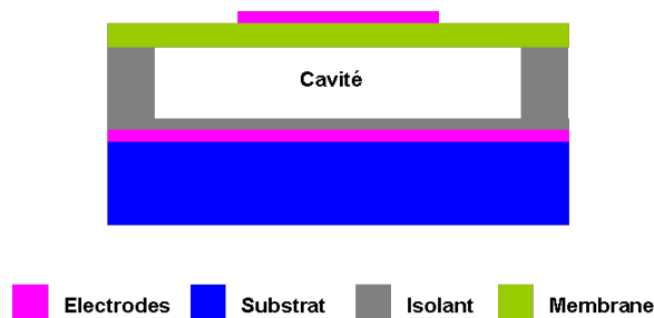
FIGURE 2.2 – Représentation schématique d’un transducteur acoustique capacitif.
