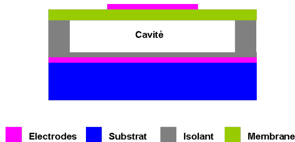
FIGURE 2.2 – Représentation schématique d’un transducteur acoustique capacitif.
