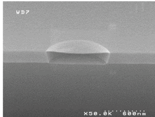
FIGURE 4.10 – Image MEB d’une membrane de silicium après amincissement. L’échantillon est clivé et ensuite observé avec une inclinaison de 90^\circ .
