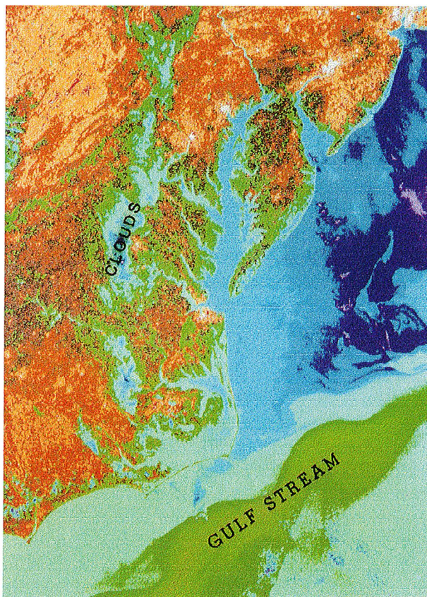
Image 3.1 : image Heat Capacity Mapping Mission acquise le 11 mai 1978 (Price, 1986) Le Gulf Stream est plus chaud que les eaux froides de l'Atlantique (bleu = froid et blanc = chaud)
