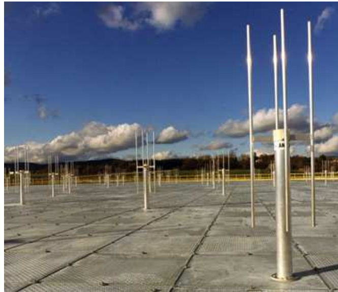
Figure 1.5 – Le site de réception du système GRAVES est composé d’un réseau d’une centaine d’antennes omnidirectionnelles. Un traitement des signaux issus des antennes de réception permet un pavage de la zone éclairée par Formation de Faisceaux par le Calcul (FFC).
