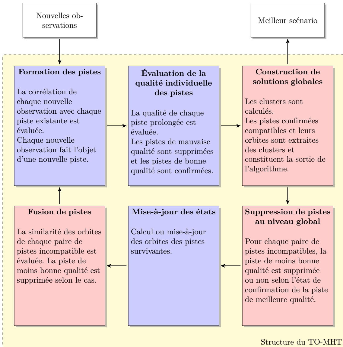
Figure 8.1 – Schéma bloc représentant les principales étapes du TO-MHT. Les blocs bleus traitent les pistes individuellement tandis que les blocs roses traitent des ensembles de pistes. La souplesse de cette algorithmne permet d’insérer et d’implémenter facilement des blocs fonctionnels comme par exemple une fonction de fusion de pistes.
