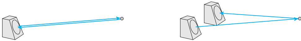
Figure 2.1 – Trajet de l'onde émise entre la cible et la ou les antennes dans le cas monostatique (gauche), et le cas bistatique (droite).
