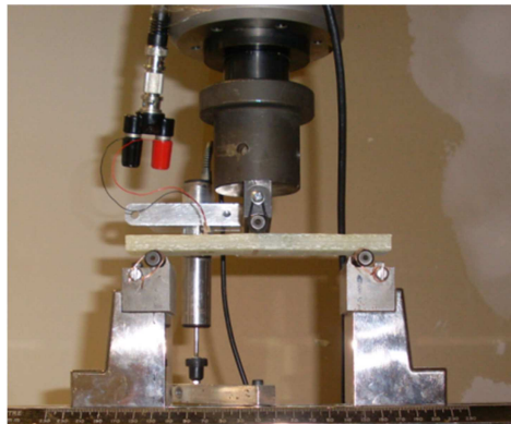
Figure 3.4. Dispositif expérimental de l'essai de flexion trois-points sur une éprouvette intégrée
