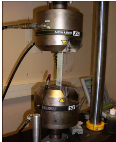
Figure 4.3. Dispositif expérimental de l'essai de traction sur une éprouvette intégrée
