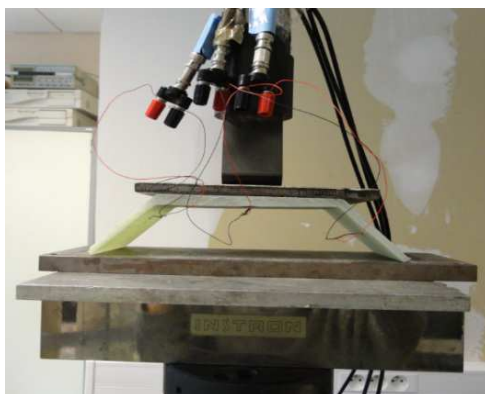
Figure 6.11. Essai de compression sur une structure en composite stratifié intégrée
