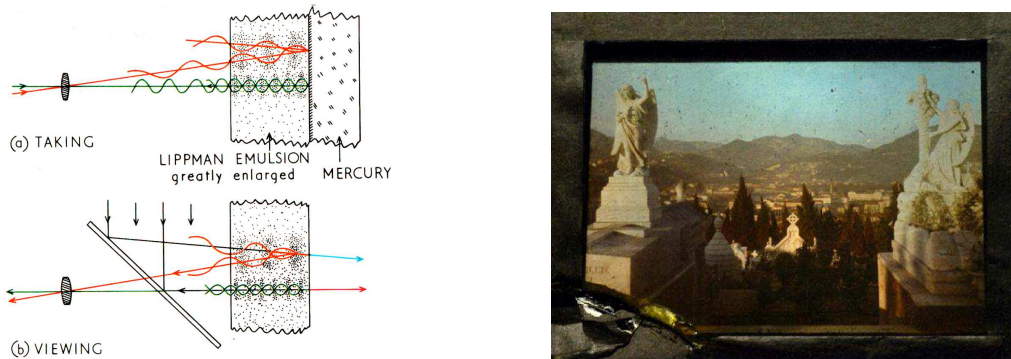
FIGURE 2.5 – A gauche : principe de la photographie couleur de Lippmann, issu de [26]. A droite : exemple d'une plaque photographique de Lippmann, "Cimetière", années 1910
